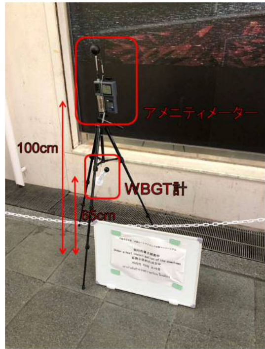
図 8 定点観測点における測器設置の様子
