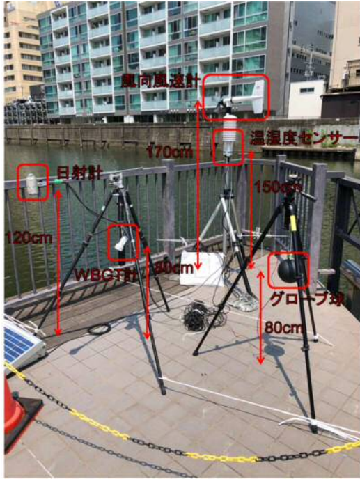
図 7 基準点における測器設置の様子
