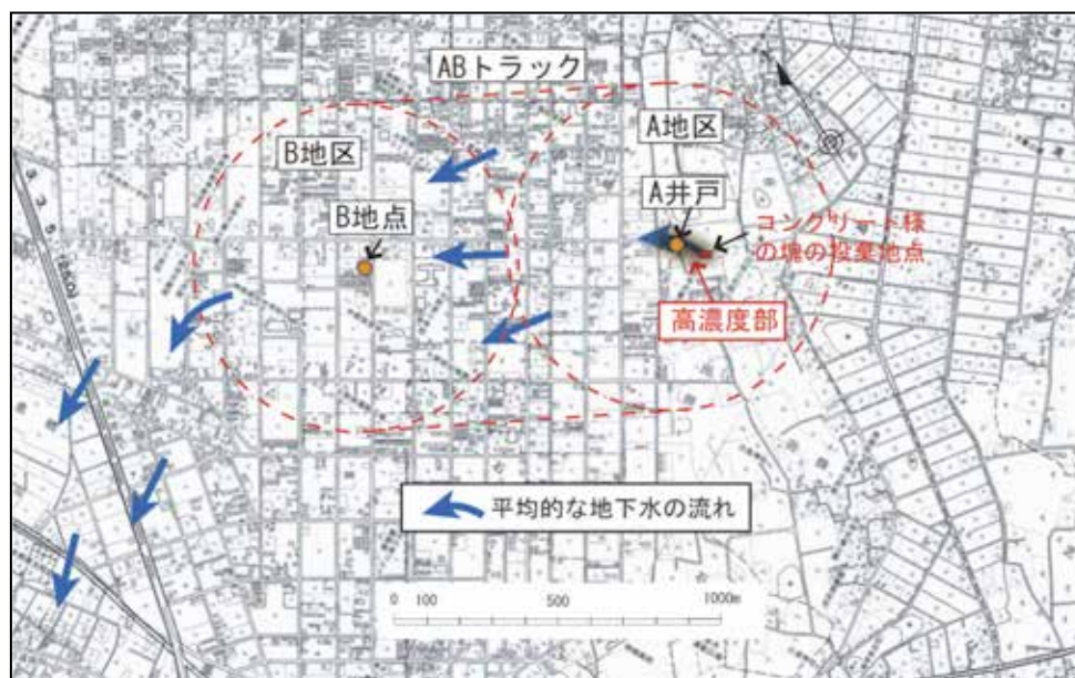
図 5 コンクリート様の塊の投棄地点と A 井戸、B 地点、A 地区、B 地区の位置関係と平均的な地下水の流れの方向
