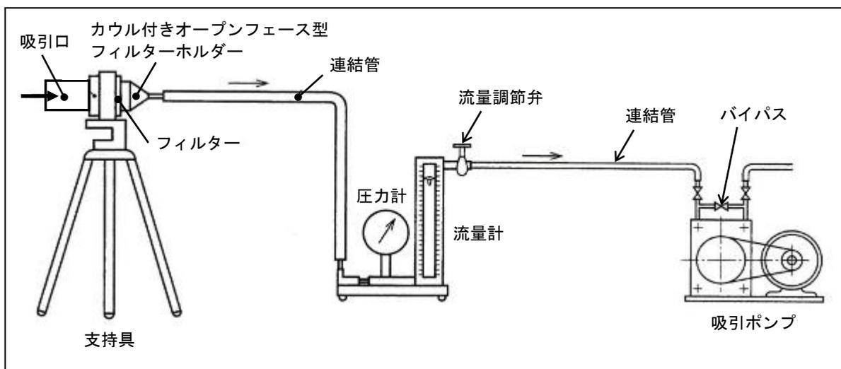
図2 捕集装置の構成の一例
