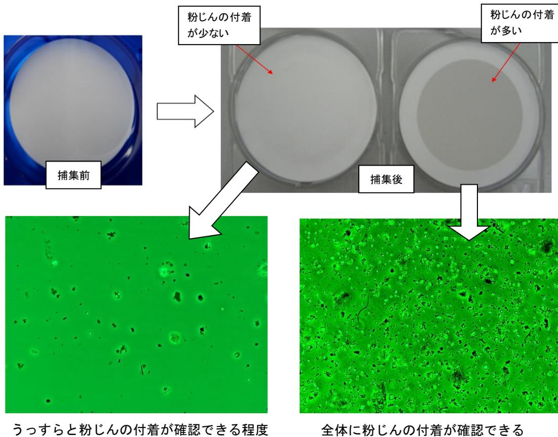
図3 フィルター上の捕集状態の一例
