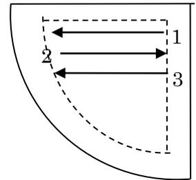
(c) グレイティクルの  $300 \mu\text{m}$  の円内の繊維を計数する。なお、計数は前頁の図のような視野の移動によって行う。フィルター切断線及び粒子付着領域の外縁から  $1\text{mm}$  以内は計数しないこととする。図のような視野の移動を行うためにはスライドガラスの側面またはフィルター切断線を東西方向に方位させなければならない。
