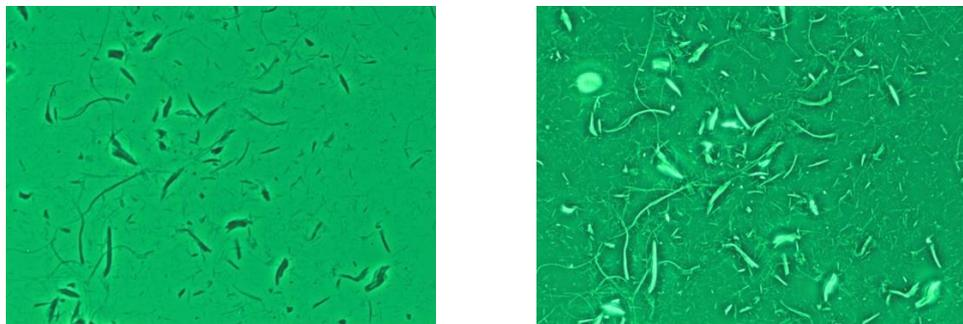
ダーク（ポジティブ）コントラスト      ブライツ（ネガティブ）コントラスト
