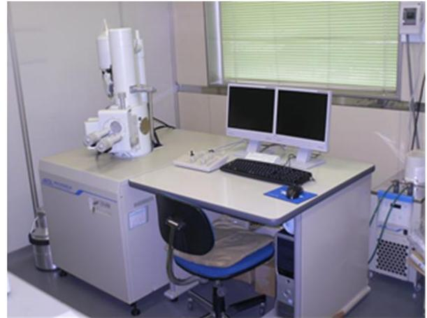
図 15 分析走査型電子顕微鏡の一例
