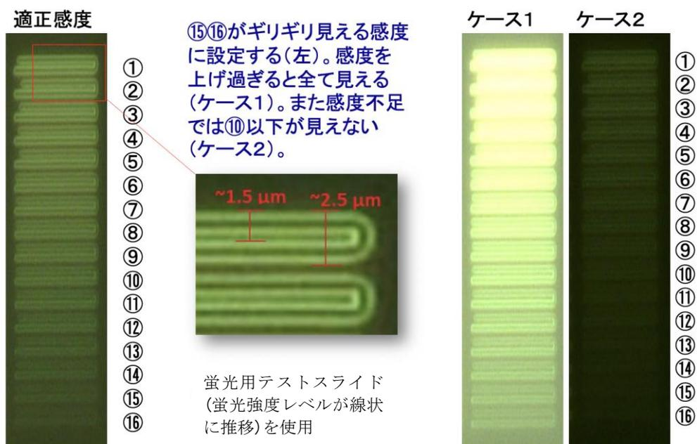
蛍光用テストスライドは、蛍光量が異なる 16 本 (①~⑯、それぞれは 4 本の微細線からなる) が描かれており、蛍光顕微鏡 (カメラセット) の感度設定に利用できる。適正な感度に合わせない場合、偽陽性や偽陰性が生じるため、テストスライドを用いた適切な精度管理が求められる。
