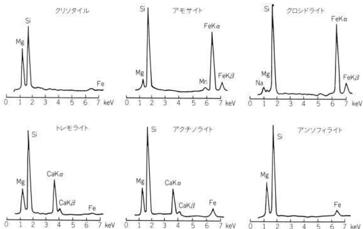
図21 アスベスト6種のEDXスペクトル図
