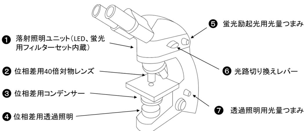
上段：一般的な位相差／蛍光顕微鏡の概略図
