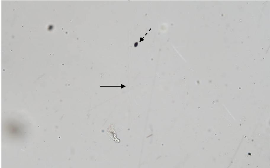
(v) ステージを回転させて繊維を垂直に方位させると、繊維がアスベストの場合背景色と同じになる。この特性によって直消光を判定する。同様の操作によって色が黒または背景より明るいコントラストになる伸長性の粒子は斜消光である。斜消光の場合、ステージを $\theta$ 度回転させて粒子のコントラストが背景色と同じになれば消光角は $\theta$ 度である。(繊維は実線矢印の先にあるが、写真 (iii)・(iv) の黒い粒子を目印に位置を推定出来る)
