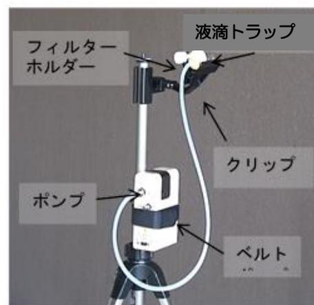
図 52 直径 13 mmオープンフェース型円形フィルターを使用した場合のサンプリング用捕集器具 一例
