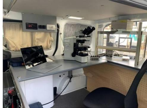
図 31 車両内に機材を設置した事例
