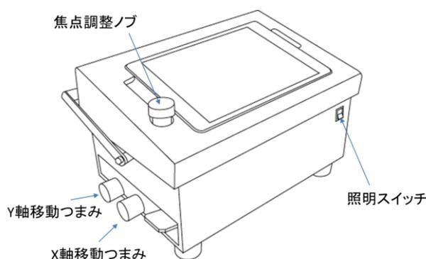
左側：可搬型蛍光顕微鏡の概略図
