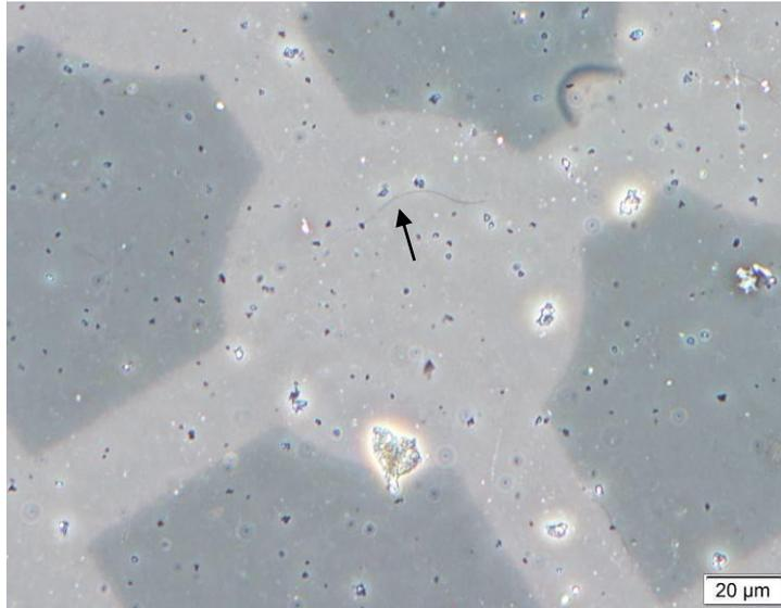
(i) 解現場の飛散クリソタイルの位相差像
