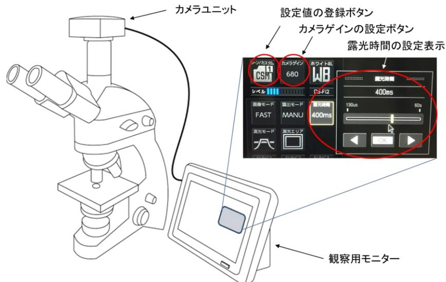
顕微鏡のカメラポートにカメラを取り付けて観察用モニターと接続することにより、観察視野の映像をモニター上に表示させ確認することができる(左)。カメラの感度をモニター上で設定(例、Wraymer社カメラ FLOYDの場合、露光時間 200ms, gain=32)することで、外部環境(明るさ)によらず一定の判定ができる。順応の問題を解決できると共に、偽陽性や偽陰性を低減できる。
