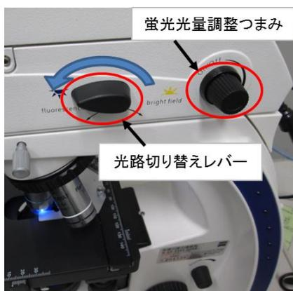
図 42 蛍光顕微鏡への切り換え
