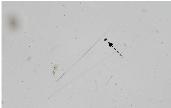
(iii) ダイヤルを反時計回りに回転させると 伸長性：正では繊維は暗くなる※1。
