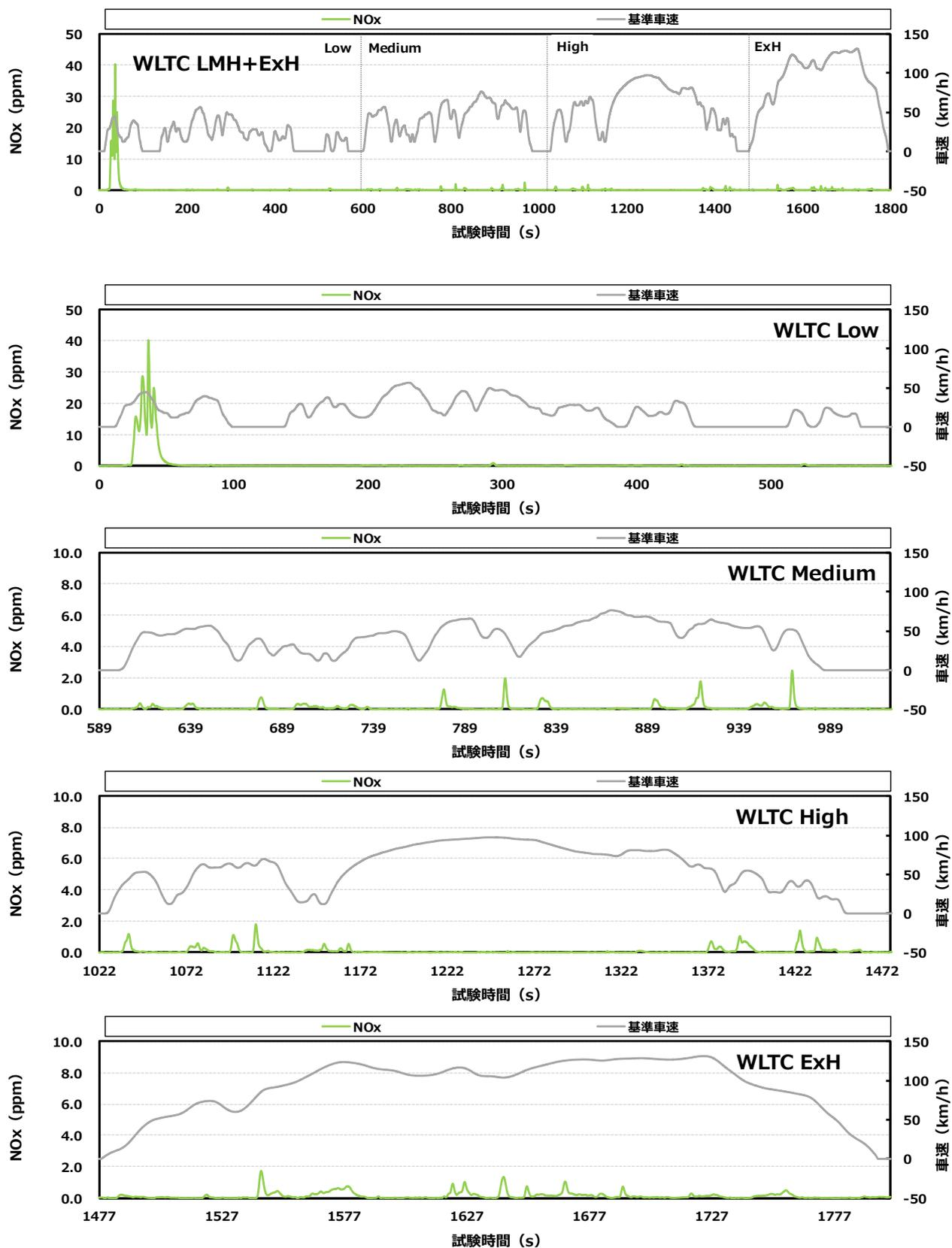
付録図 9.1 ① 認証試験用の NO<sub>x</sub> 排出挙動 (A 車)
