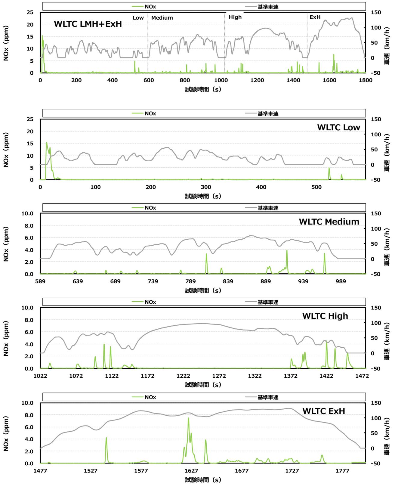
付録図 9.4 ① 認証試験用の NO<sub>x</sub> 排出挙動 (B 車)
