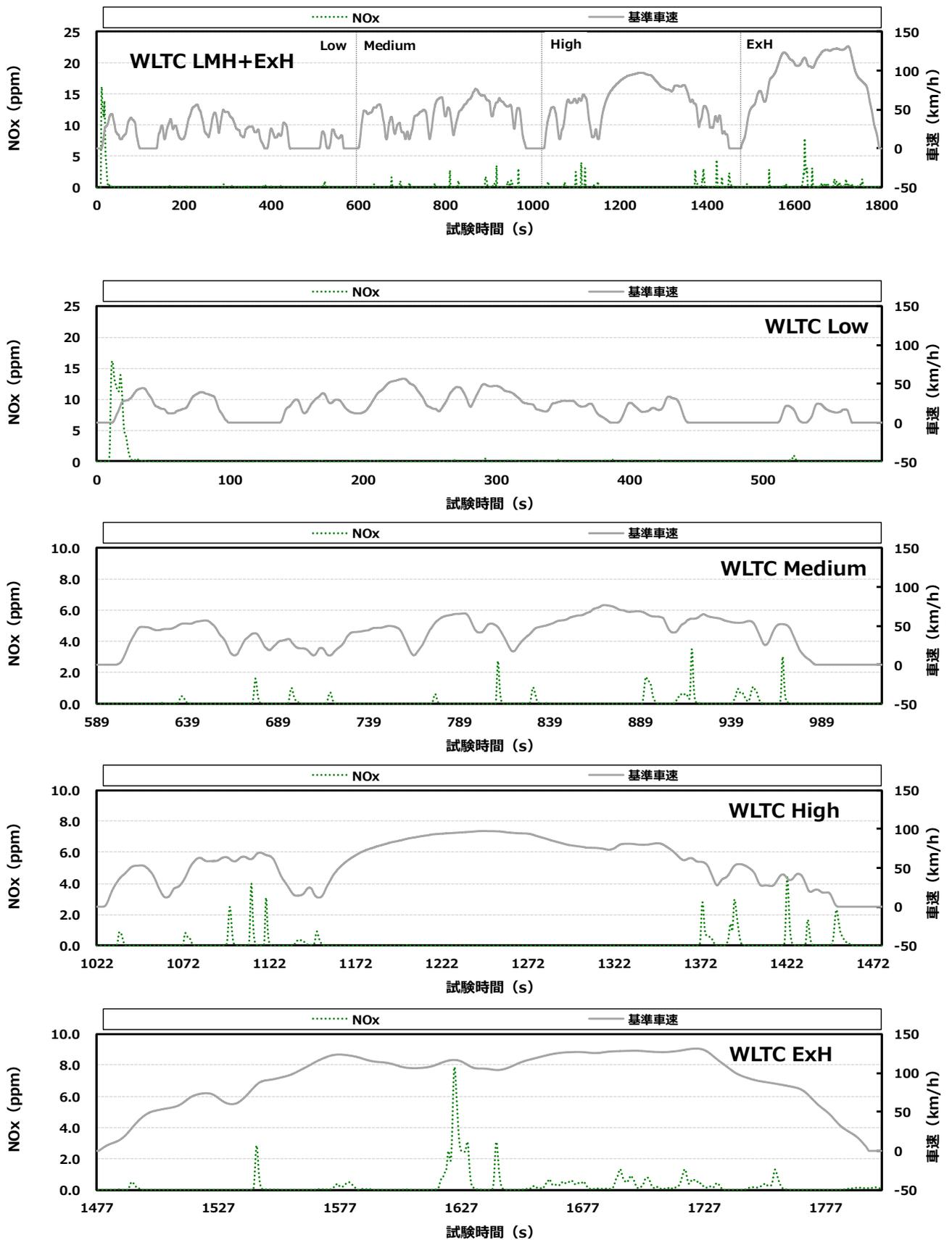
付録図 9.5 ② 認証重質化の NO<sub>x</sub> 排出挙動 (B 車)
