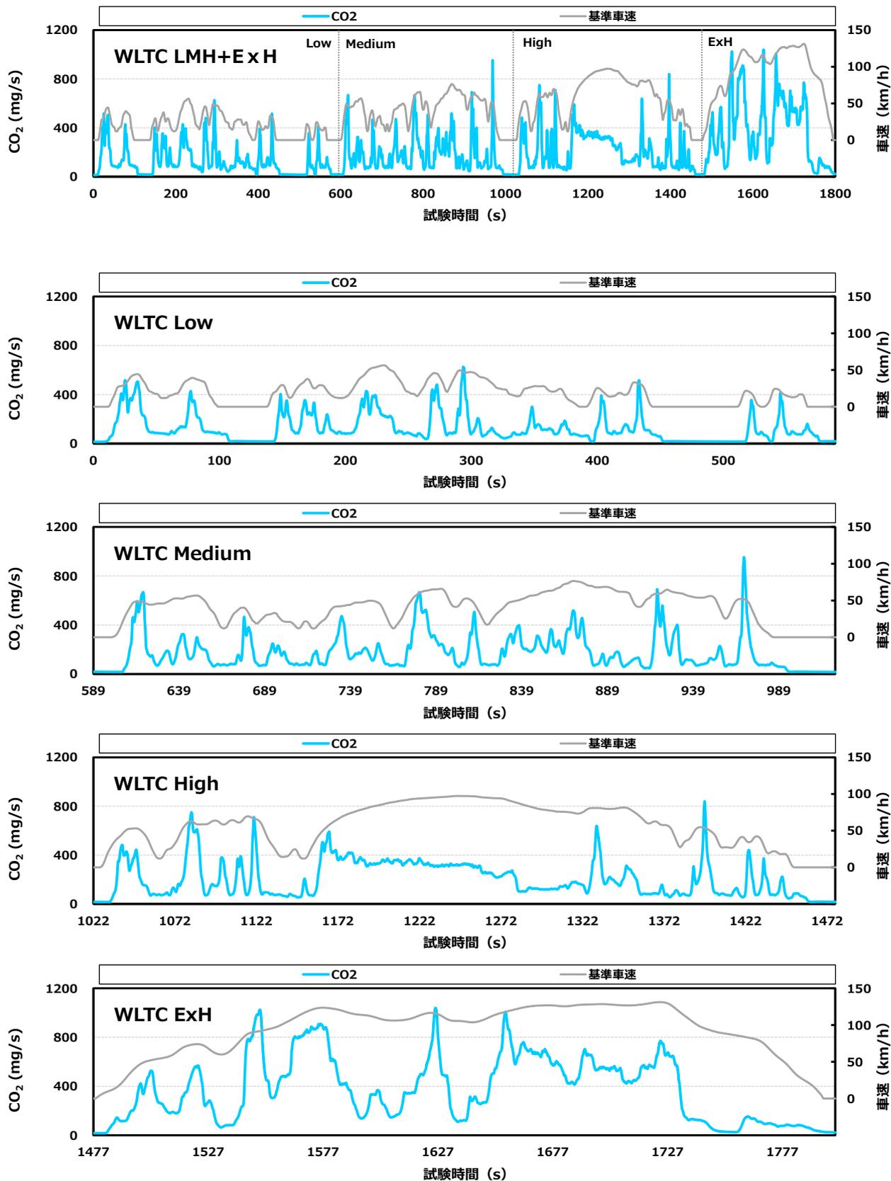
付録図 9.1 ④ 認証試験用PのCO<sub>2</sub>排出挙動 (C車)
