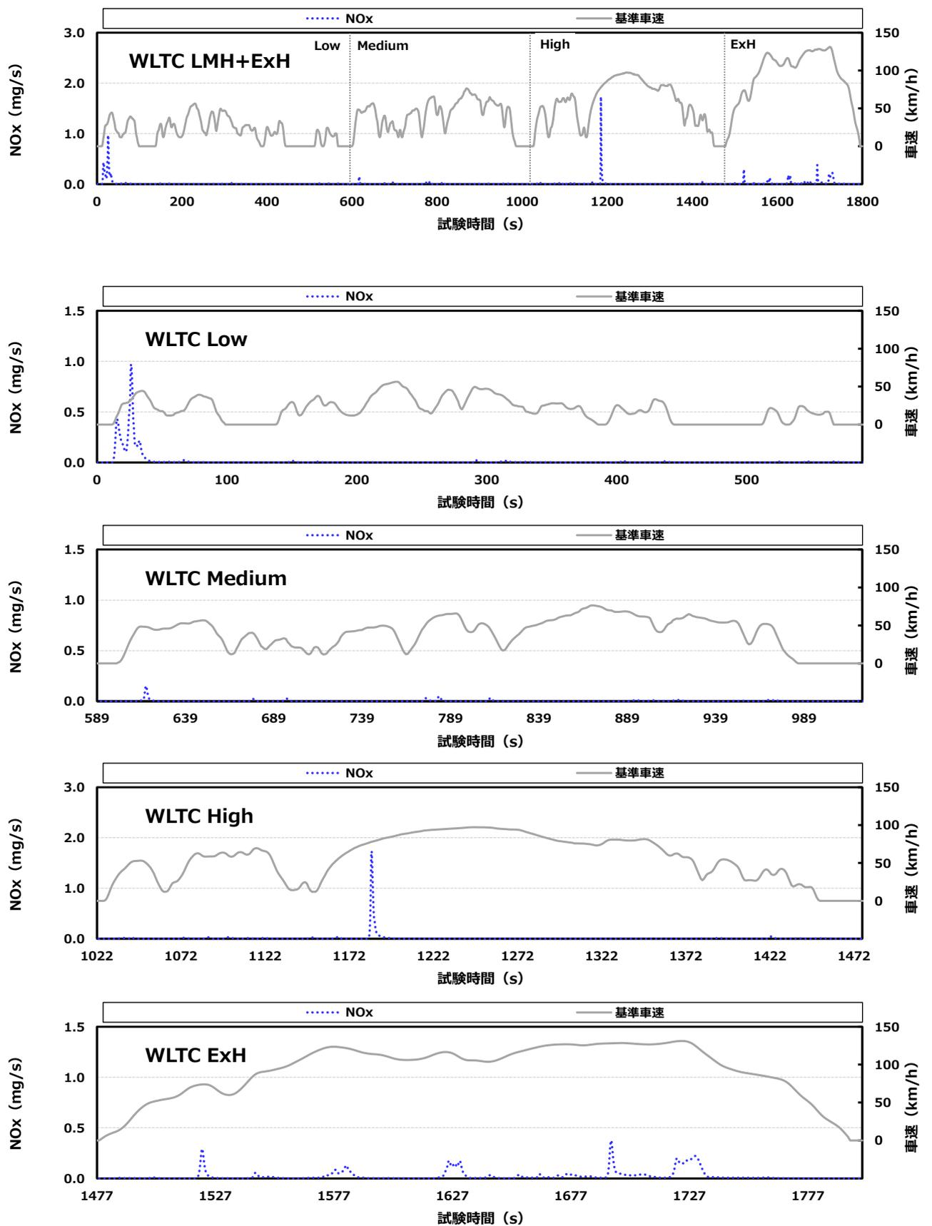
付録図 8.5 ⑤ 認証重質化PのNOx排出挙動 (D車)
