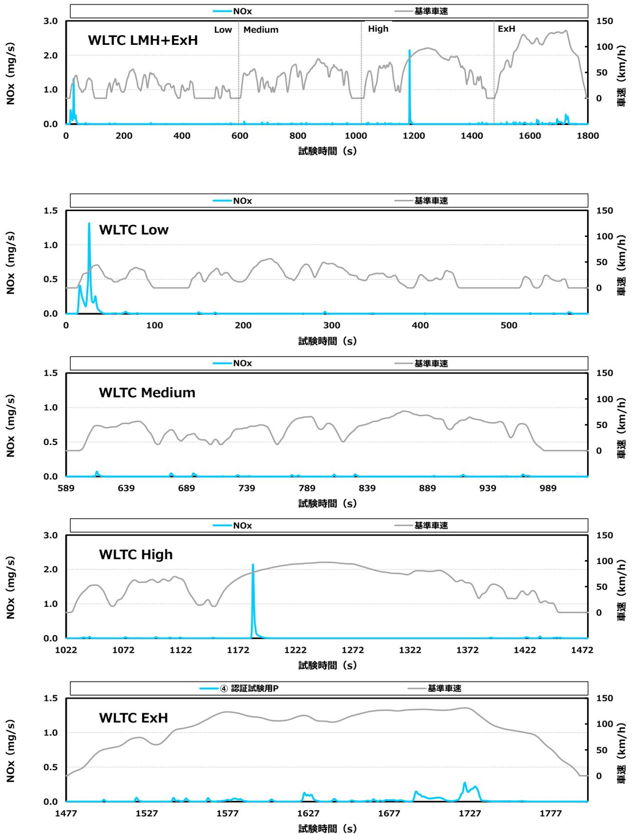
付録図 8.4 ④ 認証試験用PのNOx排出挙動 (D車)
