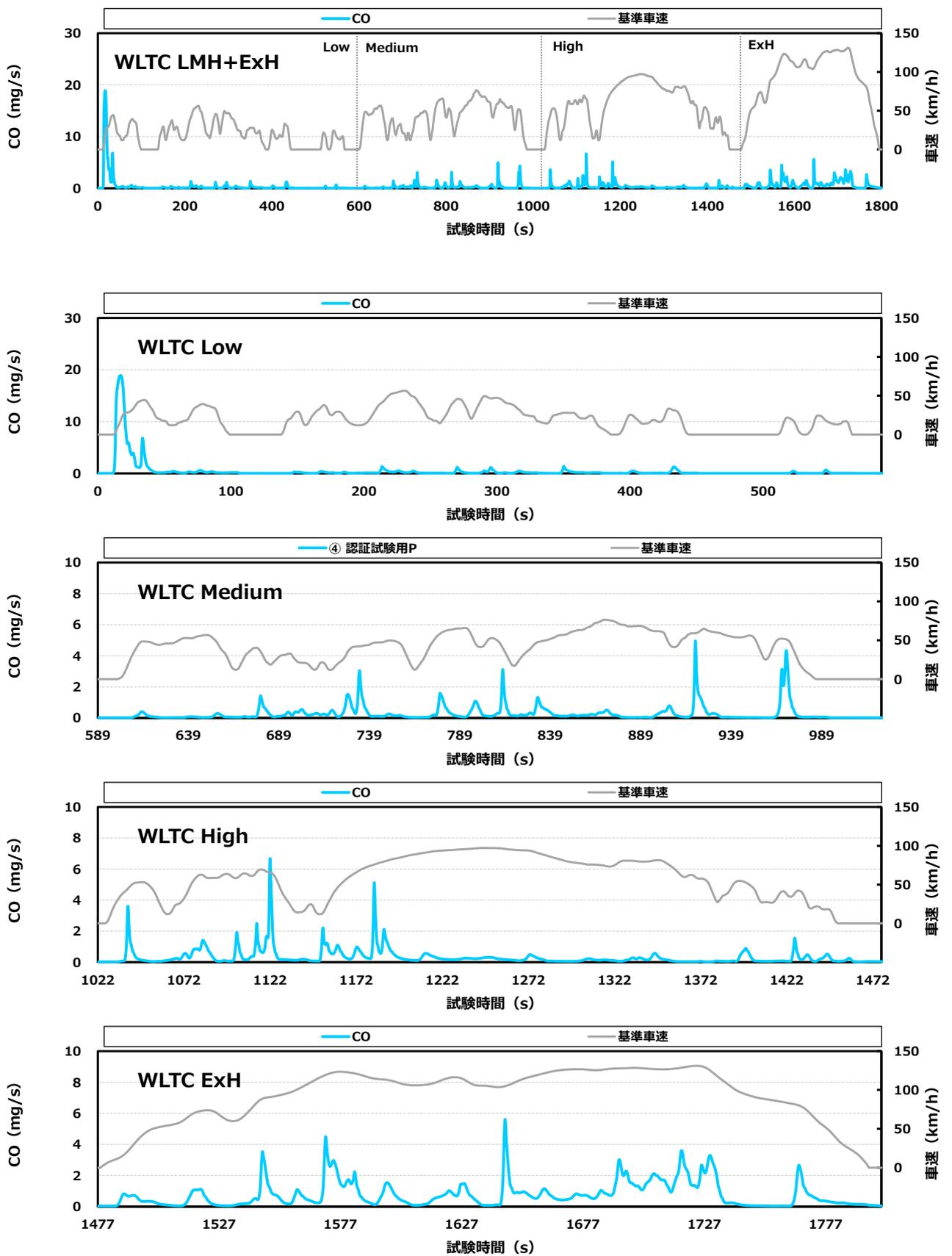
付録図 6.4 ④ 認証試験用 P の CO 排出挙動 (D 車)
