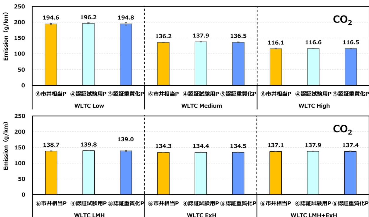
図 3.30 性状が異なる燃料によるCO<sub>2</sub>排出量の比較
