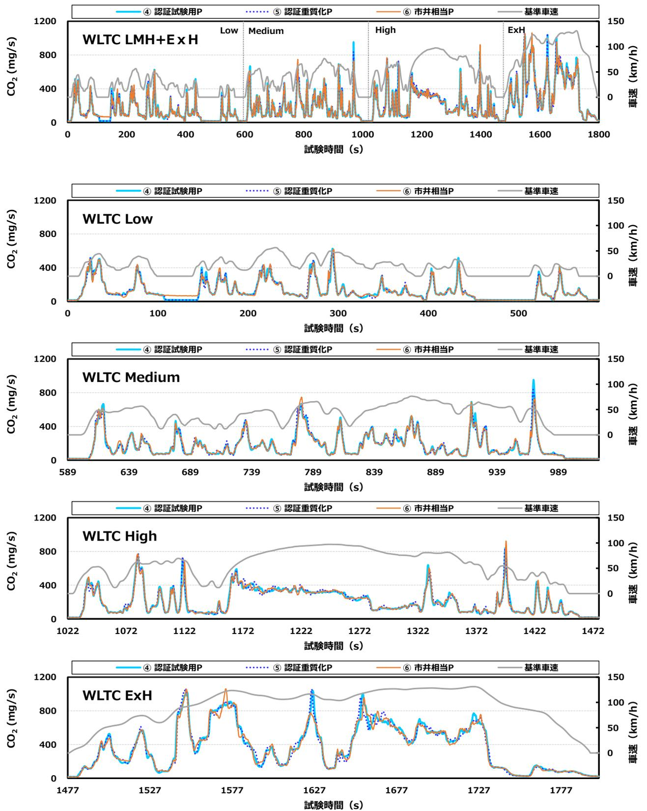
図 3.31 C 車の CO<sub>2</sub> 排出挙動の例
