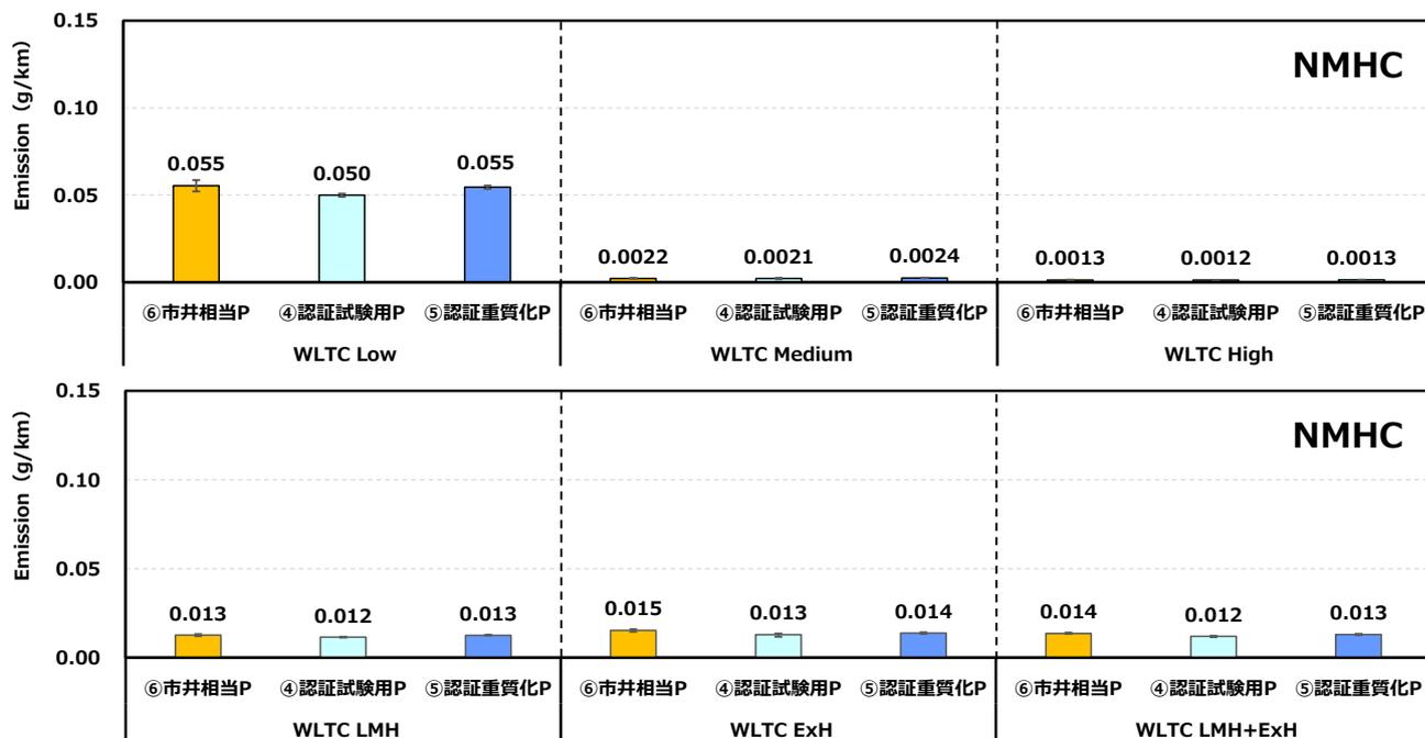
図 3.21 性状が異なる燃料による NMHC 排出量の比較
