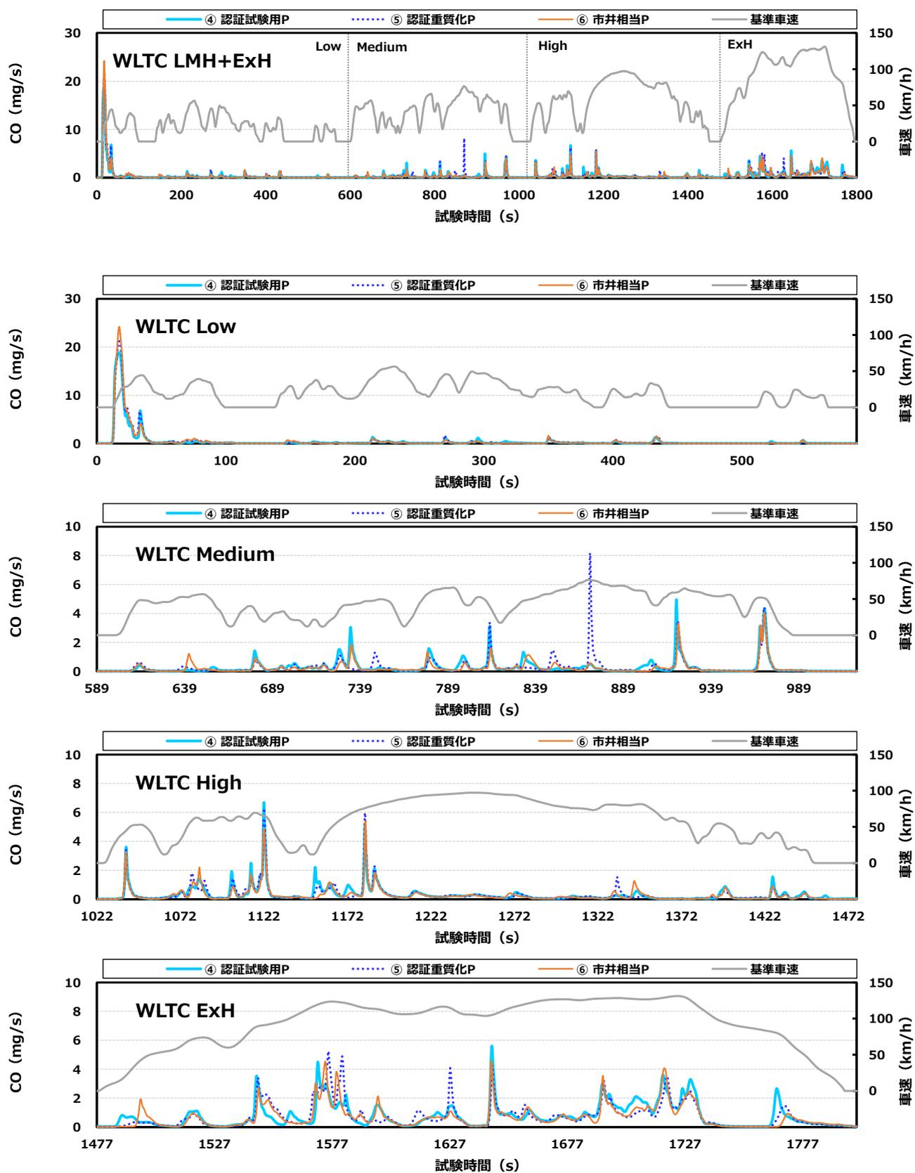
図 3.20 D 車の CO 排出挙動の例
