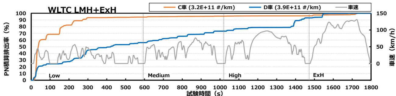
概要図 8 WLTC LMH+ExHにおけるPN積算排出量の例（燃料は④認証試験用P）
