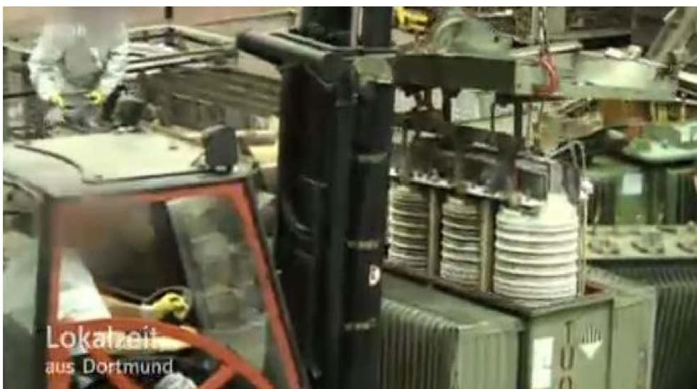
図8：能動部分の引き抜き<sup>12</sup>
