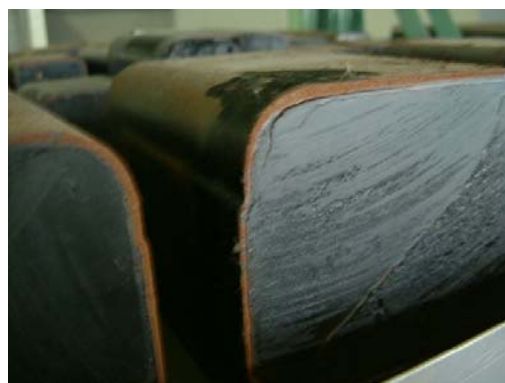
廃安定器の切断面
