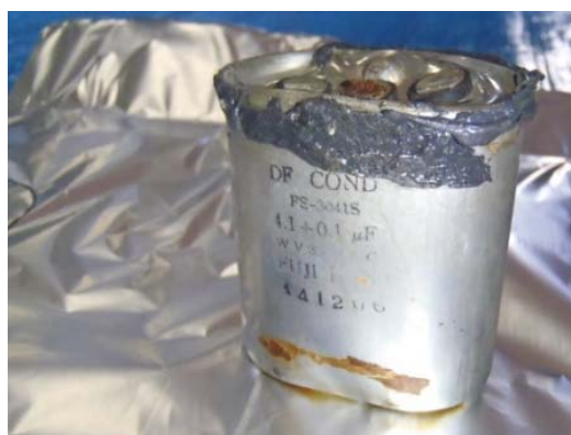
補修した剥き身コンデンサ（２）
