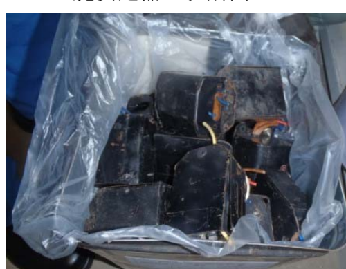
切断された廃安定器の保管例 (3)
