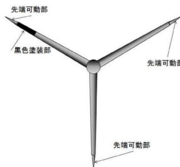
図-70 検証実験におけるブレードの彩色例
