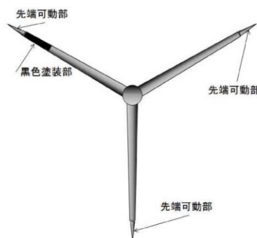
図-70 検証実験におけるブレードの彩色例 (黒色、先端部彩色)
