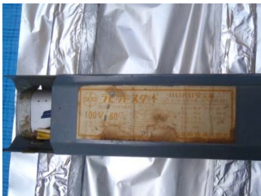
コンデンサ外付け型安定器
