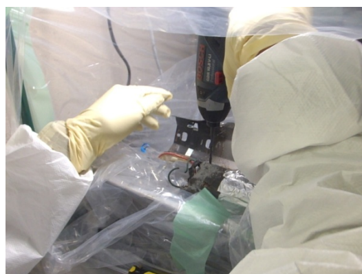
コンデンサ外付け型廃安定器充填材の採取
