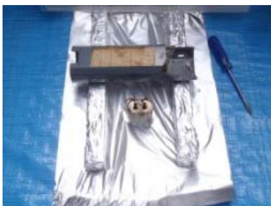
コンデンサ取り外し作業終了
