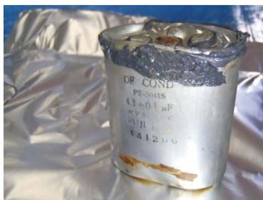
補修した剥き身コンデンサ（２）
