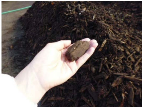
写真1 木質チップ（建築廃材などを破碎）
