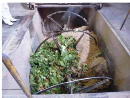
写真 1 回転式の混合機で原料を混合
