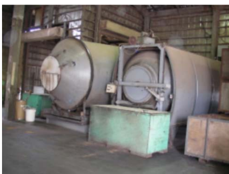
写真 2 密閉横型発酵装置 (左 : 30m 3 、右 : 15m 3 )
