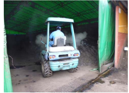
写真6 後期工程での攪拌作業
