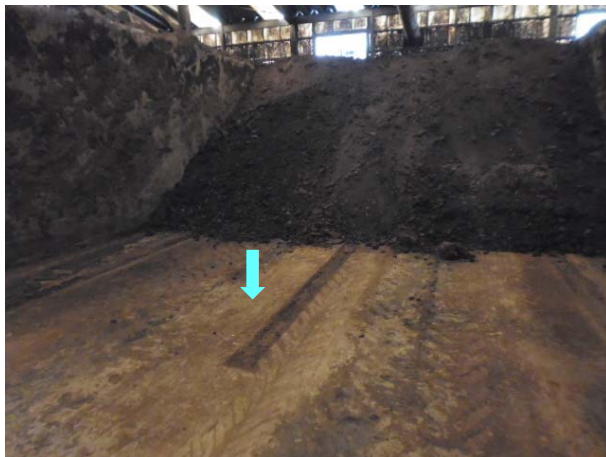
写真 3 発酵槽の床面からのエアレーション
