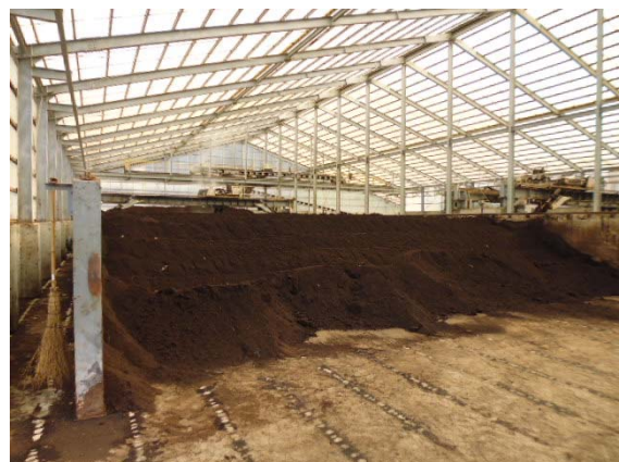
写真4 二次発酵棟（スクリー式の攪拌機）
