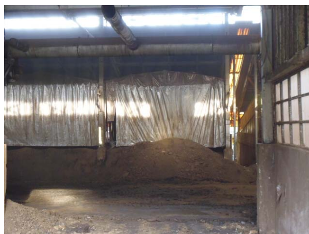
写真4 発酵槽をビニールハウスで覆い吸引している
