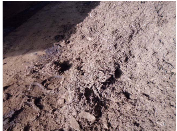
写真6 生物脱臭槽に積んでいるバーク
