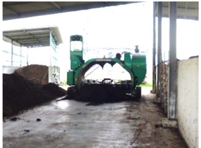
写真7 自走式の攪拌機
