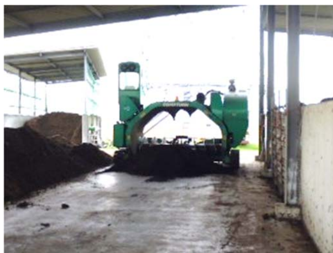
写真7 自走式の攪拌機
