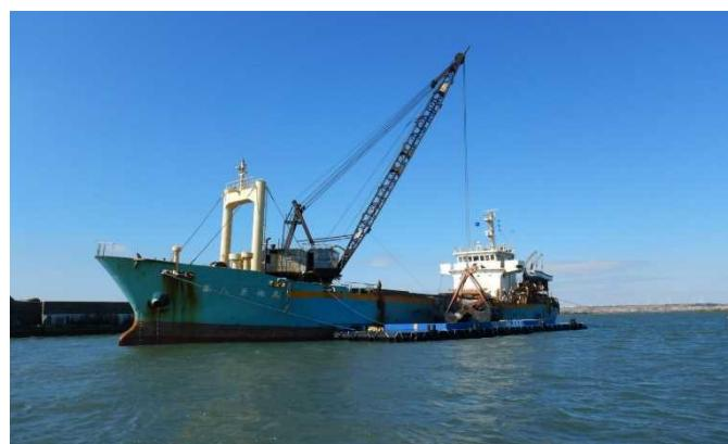
写真-2 土運船からガット船への積み替え状況
