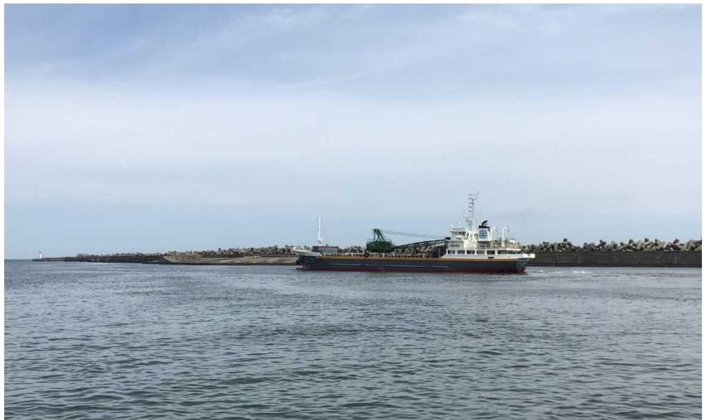
写真-3 ガット船によるしゅんせつ土砂の運搬状況
