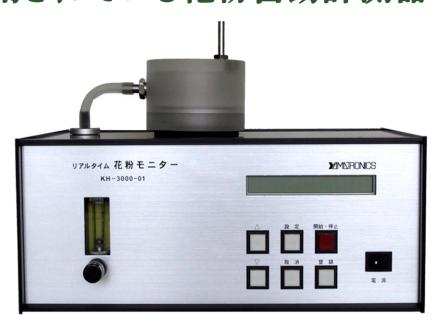
リアルタイム花粉モニター「KH-3000-01」は、光源に半導体レーザーを用いて、花粉を自動的に計数して、その結果をプリンターまたはパソコンに出力するポータブルタイプの全自動花粉計測器です。
