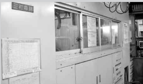
フル稼働の自動4槽式洗浄装置
