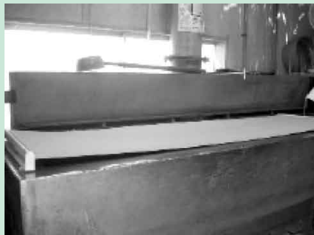
装置上部のロールスクリーンと側面及び後面のビニールシート
