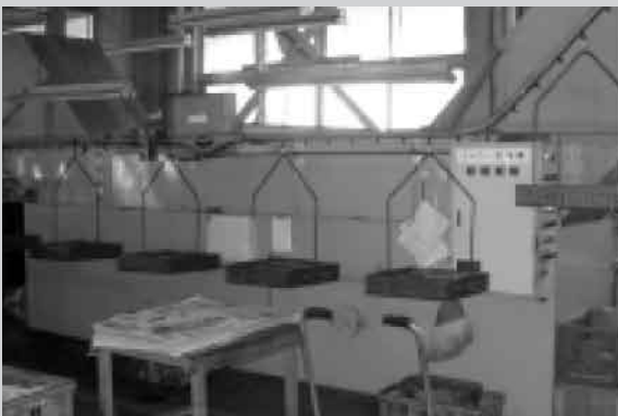
自動3槽式洗浄装置(シャワー式)の外観
