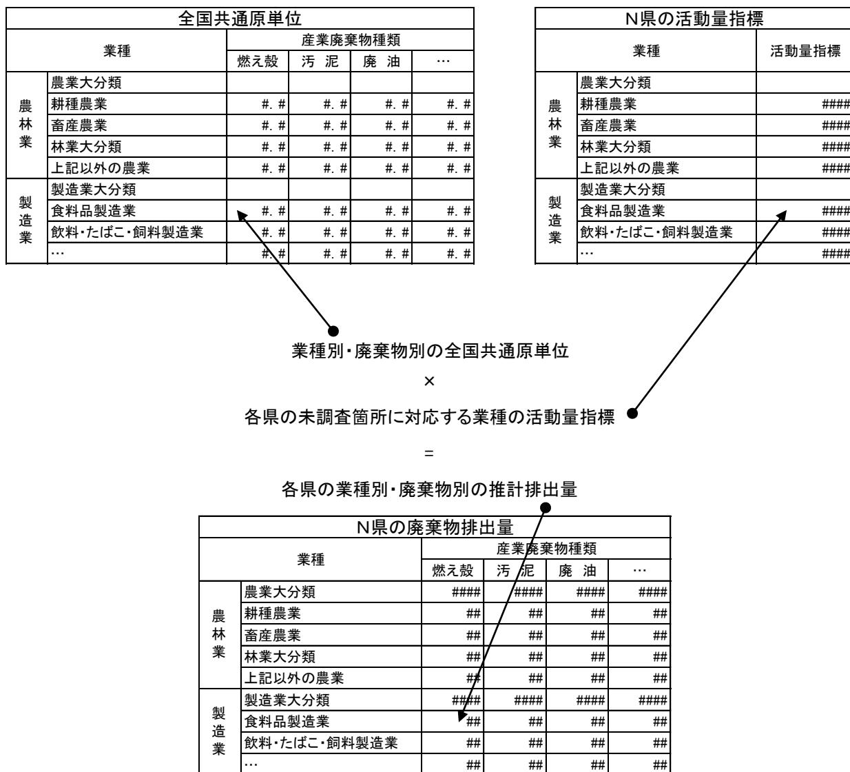
図一 II・7 原単位法による排出量推計方法
