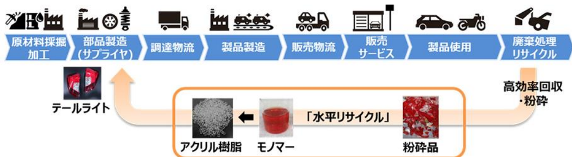
図 1-4 本田技研工業によるアクリル樹脂の水平リサイクル概念図
