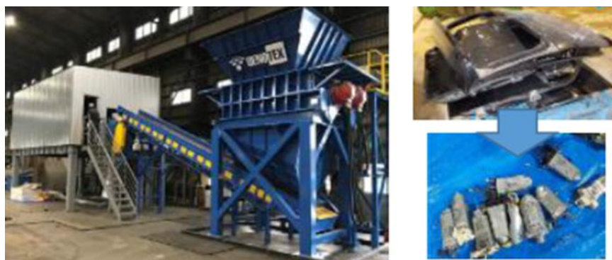
図 1-9 二軸前処理装置(左)、投入前(右上)と回収したモーター(右下)
