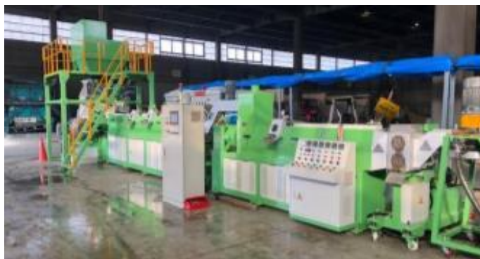
図 1-8 レーザーフィルター付きペレタイザー
