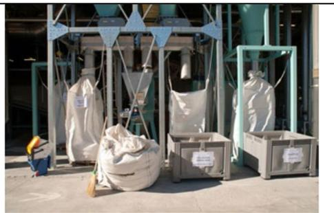
プラスチックは、光学選別機によりPEとPP及びセルロース残渣にさらに選別され、PEとPPはペレット化される。
