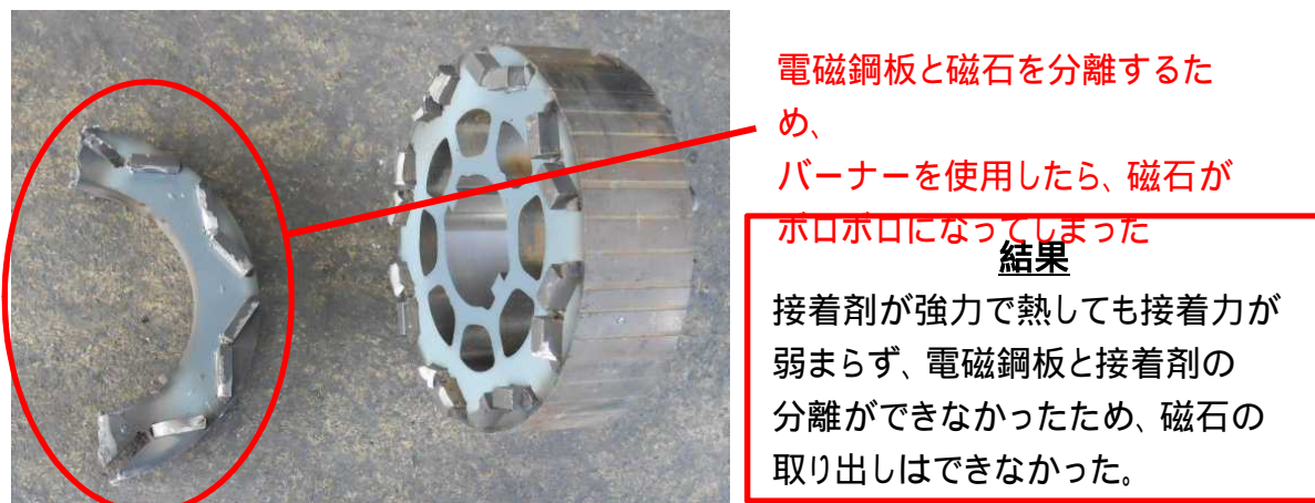
図表 4-11 トヨタアクアでの作業の様子（磁石取り出し失敗）
