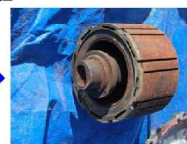
消磁後 加熱により磁力が消えたため、何もくっつかない。
