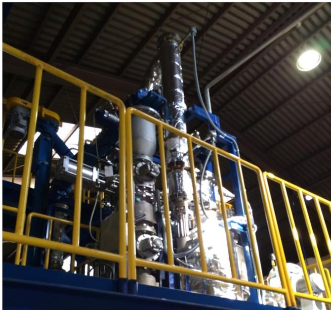
図 4-9 接触分解方式による油化プラントの還流塔
