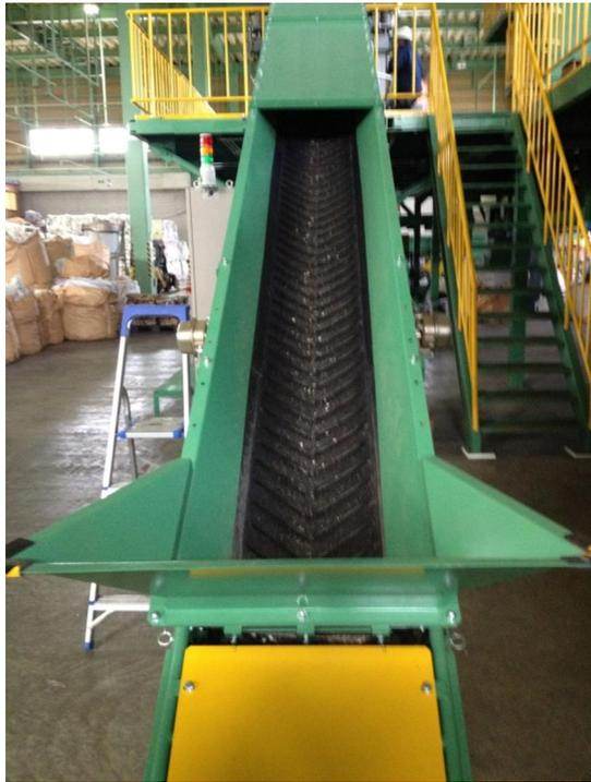
図 2-3 投入口と投入コンベア
