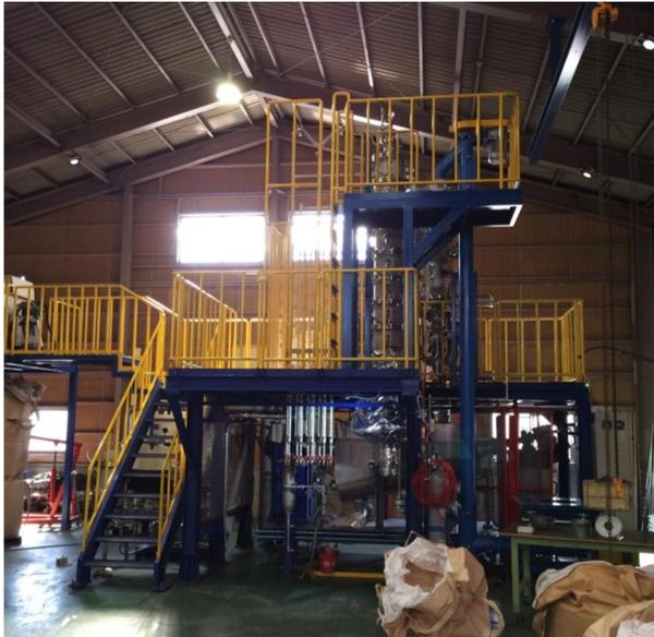
図 4-3 接触分解方式による油化プラント
