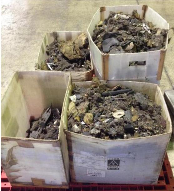
図 1-6 サンプリングした 60.52kg の ASR
