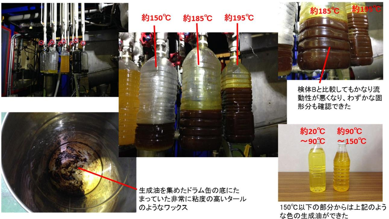
図 4-12 油化実証試験の回収油の状況
