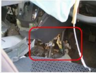
写真① コンソールパネル裏などに コンピュータが設置
