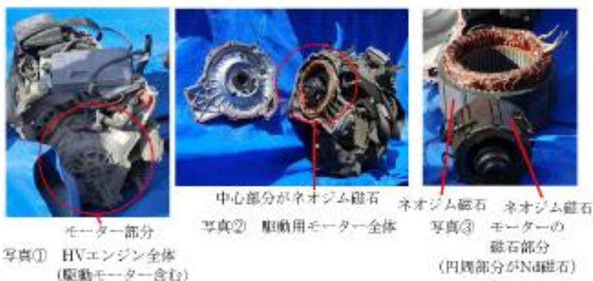
図4-5 HV車のエンジン・モーターの解体状況
