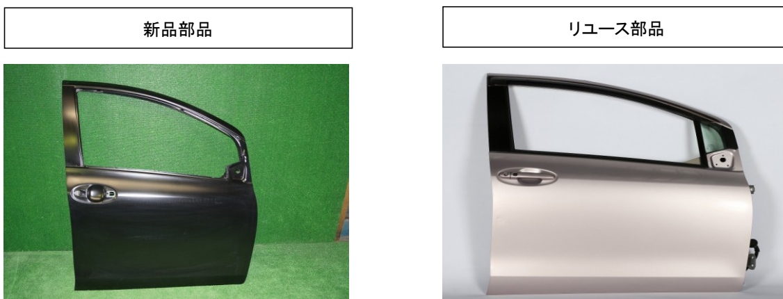
図 1-2 新品部品とリユース部品の違い(ドアの場合)
