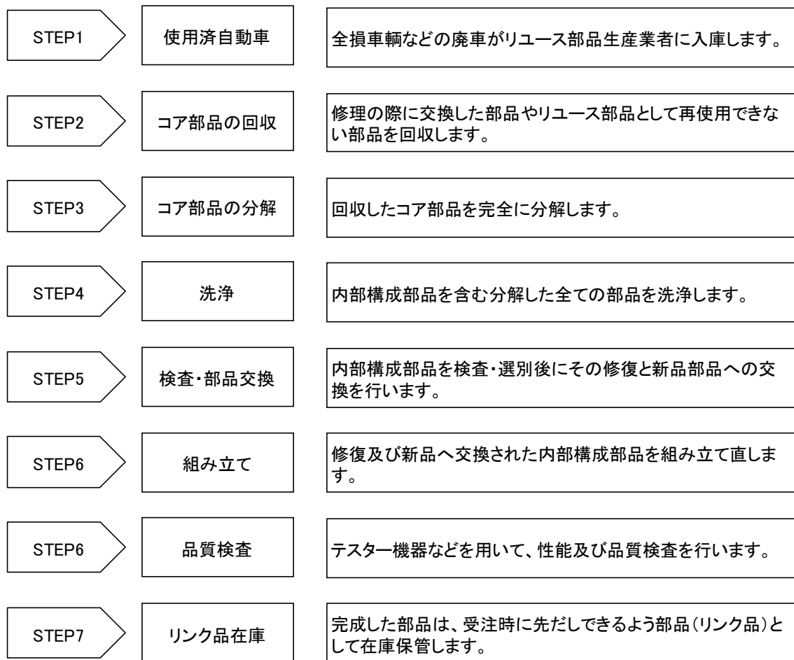
図 2-2 リビルト部品の製造フロー
