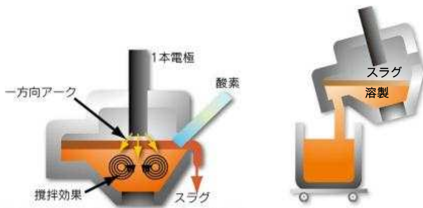
図 4.2 電気炉および偏心炉底出鋼
