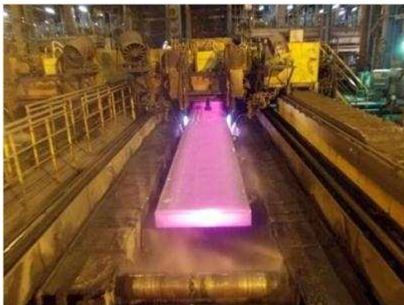
図 4.13 連続 casting 中の写真(鋼片の切断作業)
