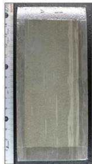
图 7.41 CCT 腐食減量試験片外觀写真 試作材(試験前, 噴霧 96Hr 後)
