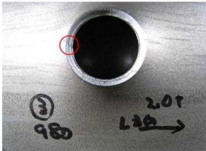
図 7.27 穴広げ試験後の試験片外観写真(試作材 酸洗鋼板)
