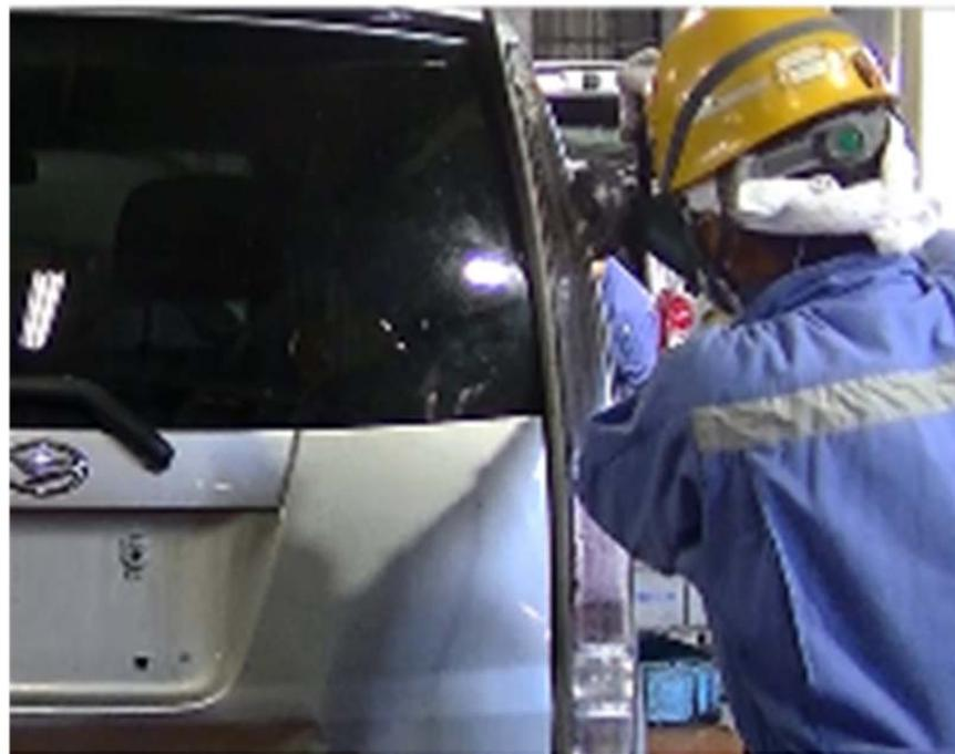
テールランプの形状によっては、ダイヤモンドカッターで切削するよりも、トンカチなので割り回収の方が効率的な場合もある。
