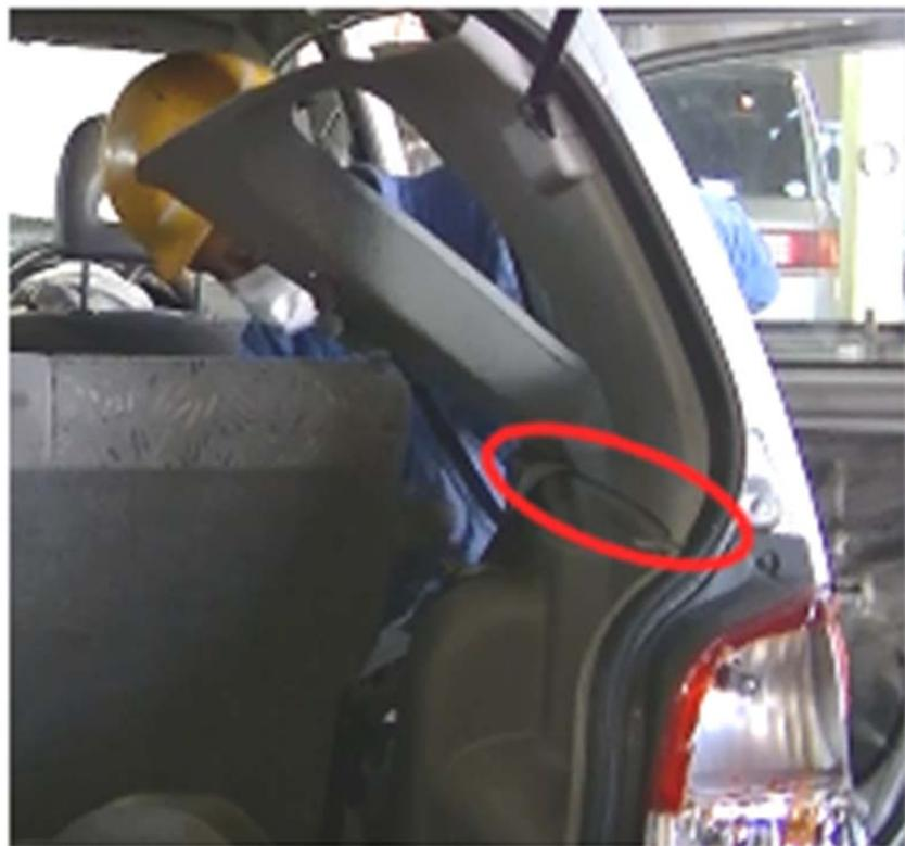
ピラーにトランク内張りがかかっていることが多いので、トランク内張りを解体後にピラーを解体すると更に時間短縮をすることができる。
