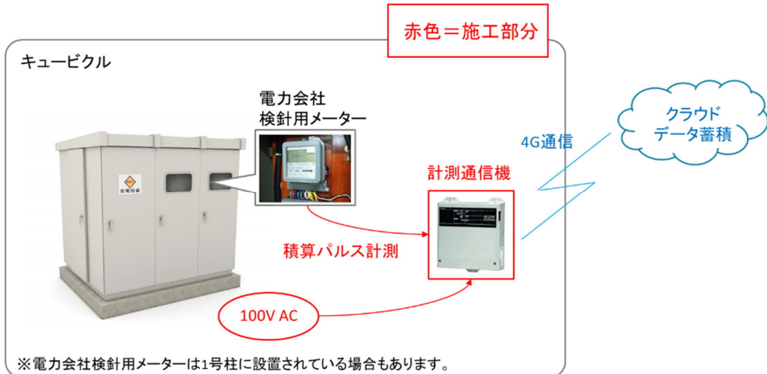
図 4.3-8 電力の計測構成イメージ
