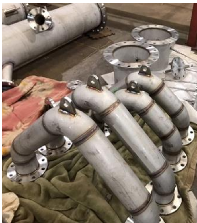
図 4-2-7 吸収塔の接続配管
