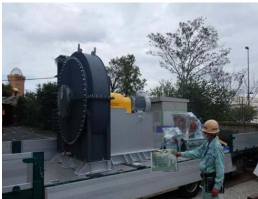
図 5-3-6 排ガス誘引送風機の納入時の状況
