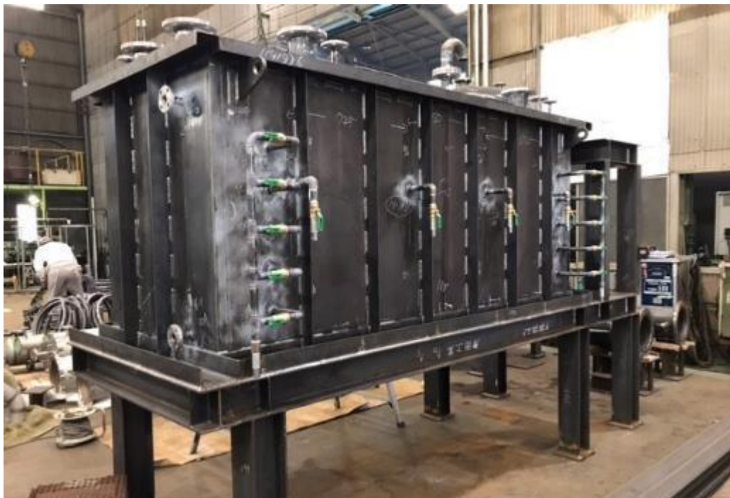
図 4-2-4 タール・飛灰分離槽
