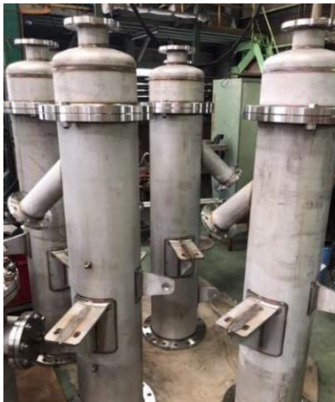
図 4-2-1 急冷塔および吸収塔
