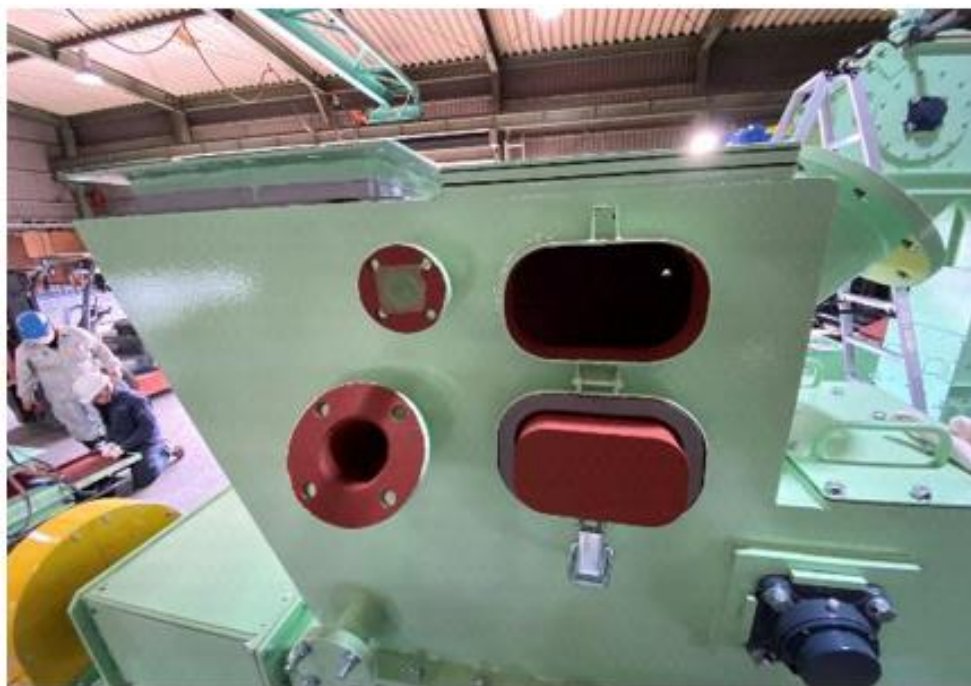
図 5-3-3 給じん装置の製作時の状況
