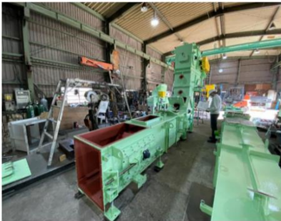
図 5-3-1 破碎ごみ供給コンベアの製作時の状況
