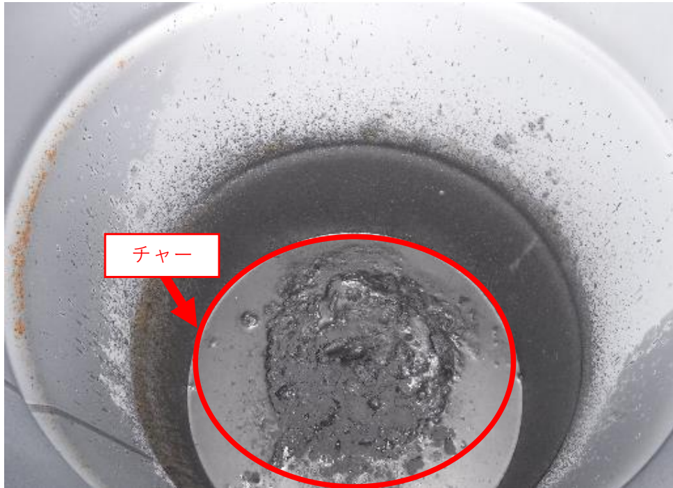
図 5-6-12 運転後の排出チャー受けの底部に溜まったチャー
