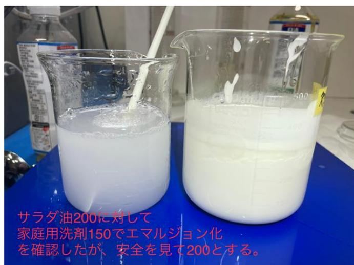
図 2-2-35 サラダ油の乳化試験
