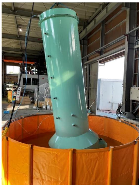
図 2-1-8 フランジ面からのガス漏れ確認
