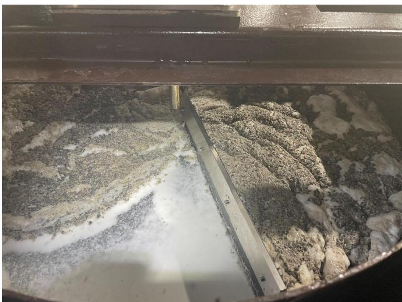
図 2-2-31 無薬注で加圧浮上処理の状況
