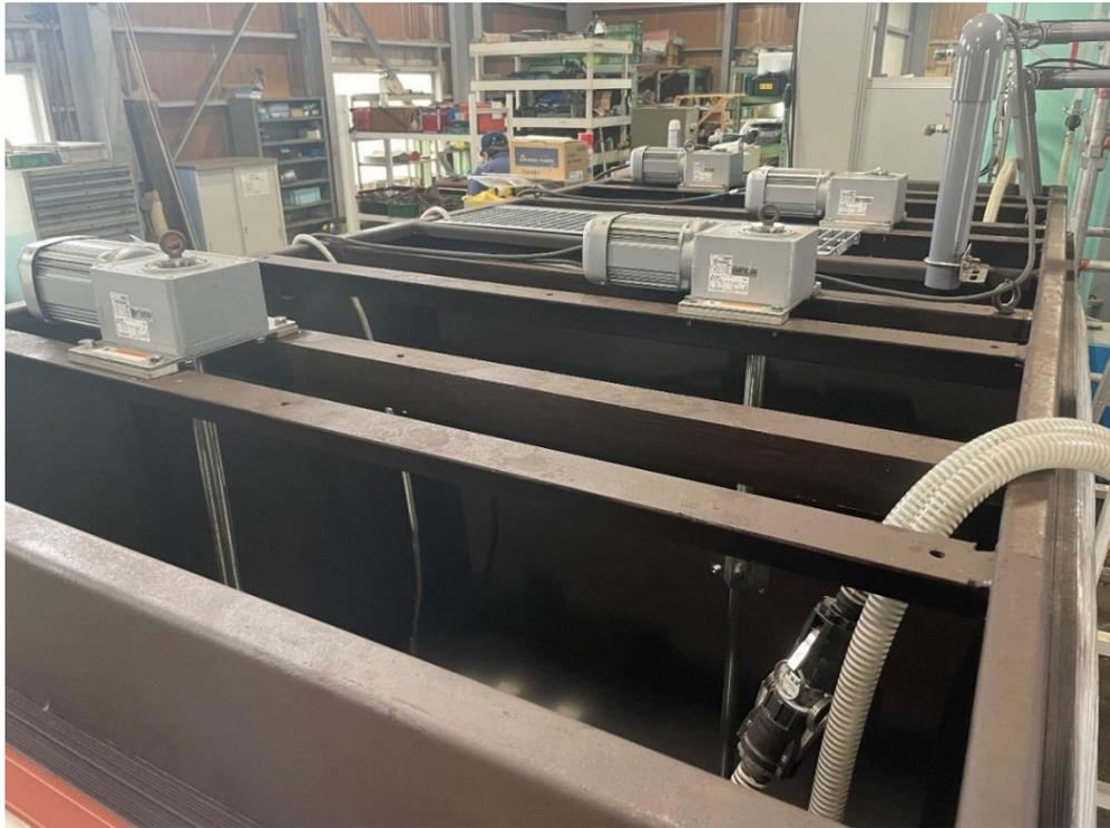
図 2-1-13 前処理槽製作状況
