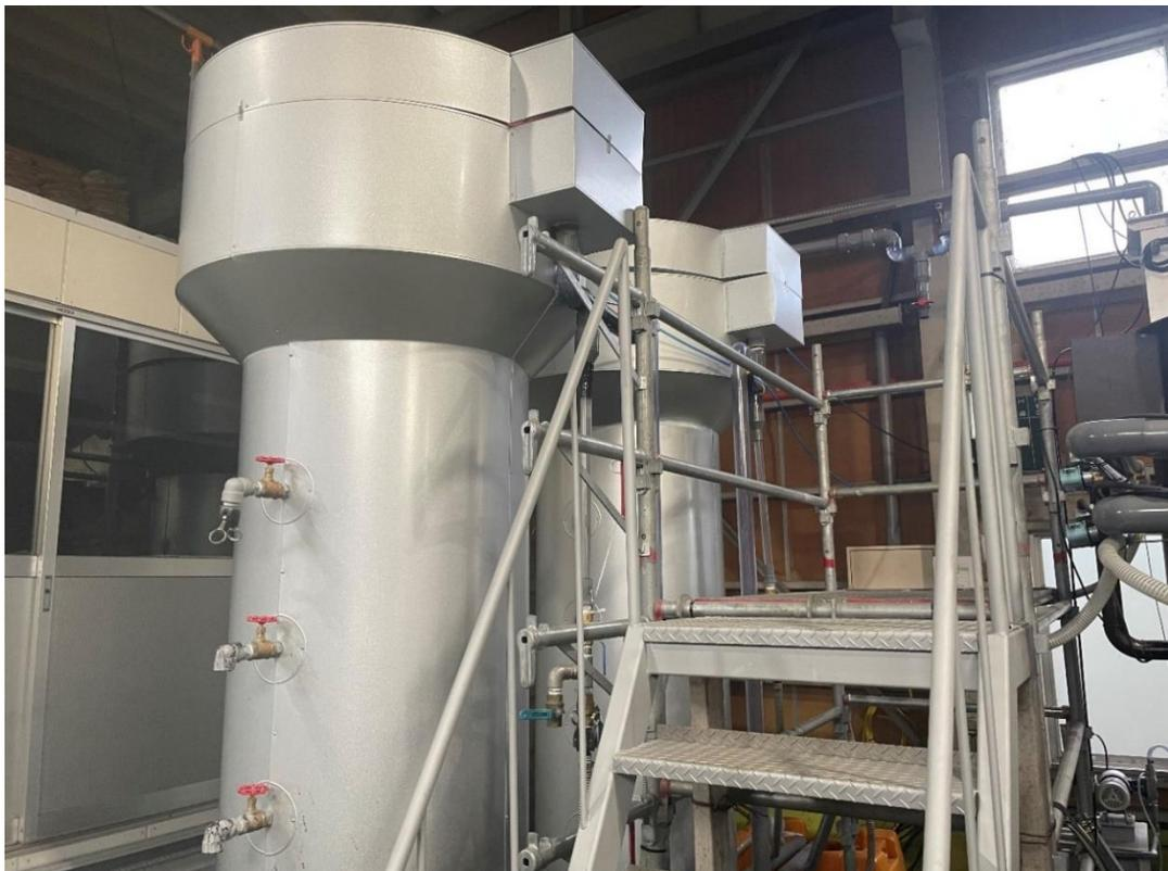
図 2-1-10 保温後の UASB 槽外観
