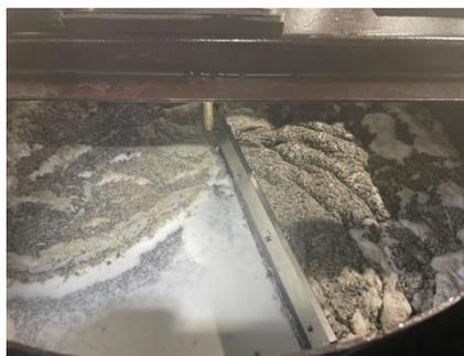
図 厨房排水の加圧処理状況
