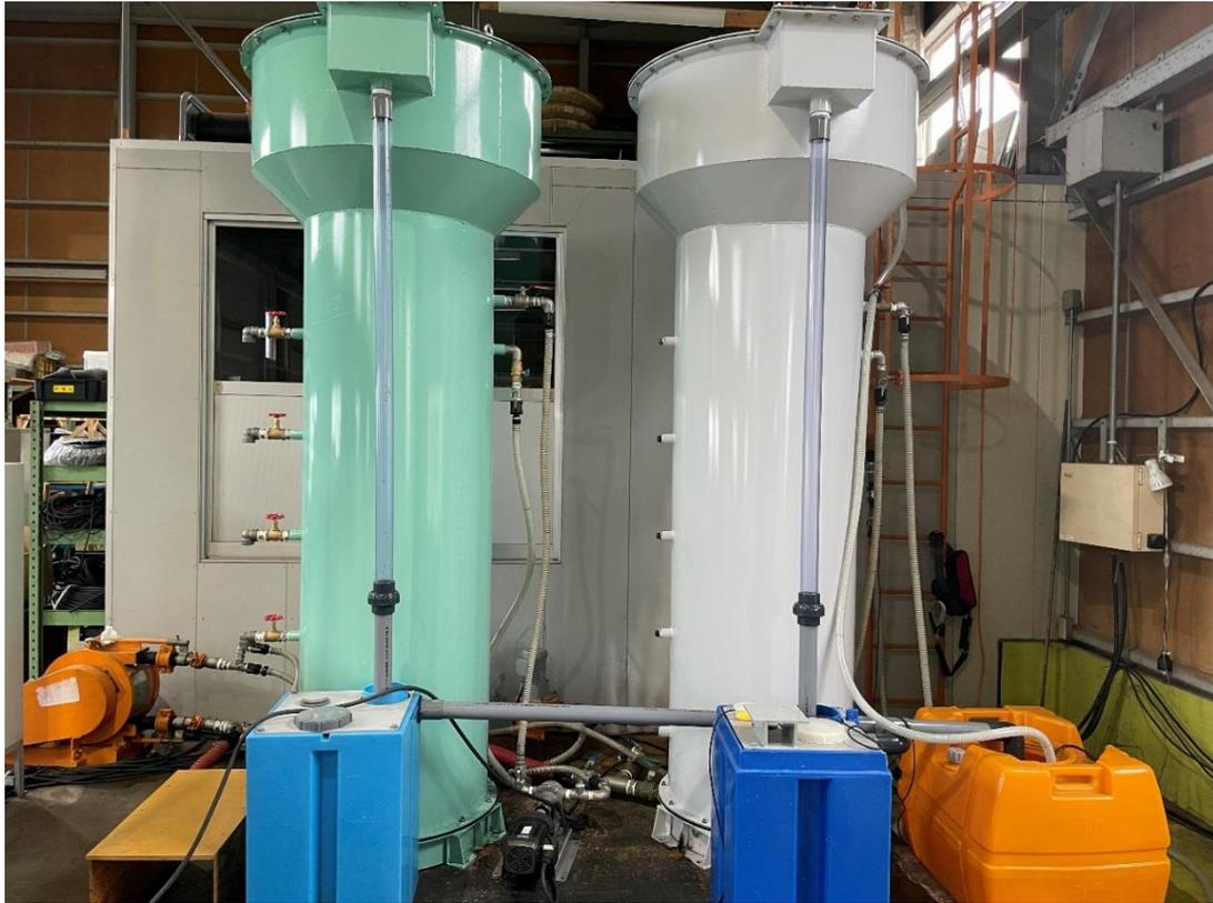
図 2-1-9 保温前の UASB 槽、水封槽外観
