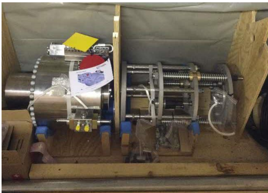
図 3-23 圧力波式スートブロワ本体
