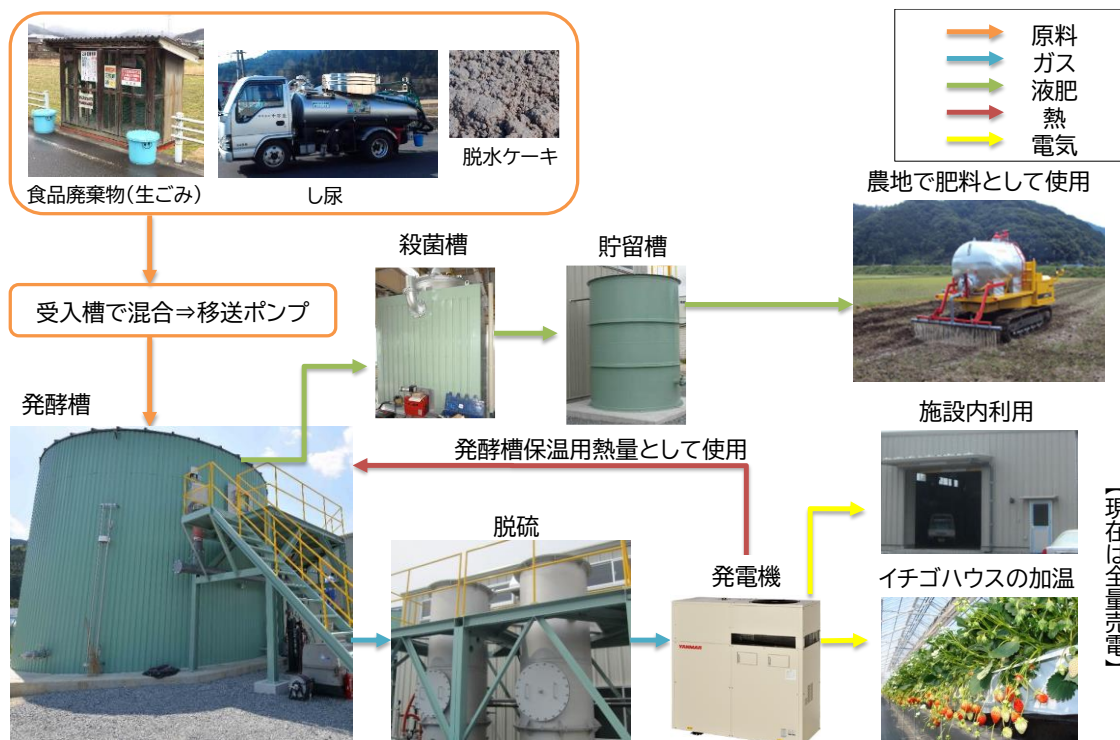
図 1-4 既存プラントの概要フロー
