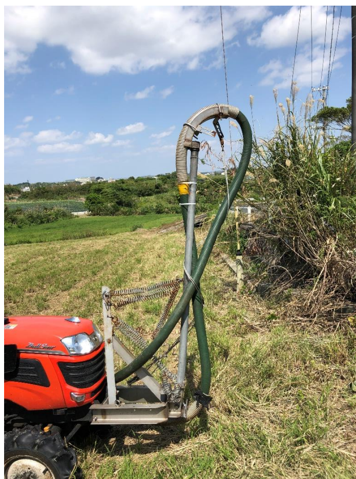
図14 トラクタへのホースの接続方法
