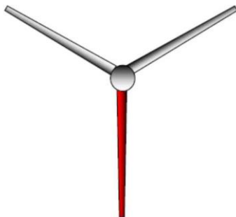
図-59 1枚のブレードの彩色例 (赤色、根元から先端部彩色)
