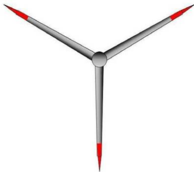
図-57 3枚のブレードの彩色例 (赤色、先端部彩色)
