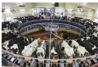
搾乳設備（ロータリーパーラー）
