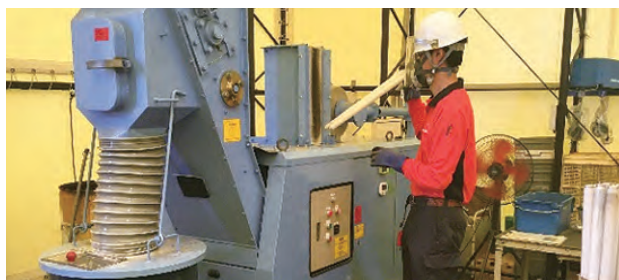
蛍光管破碎作業
