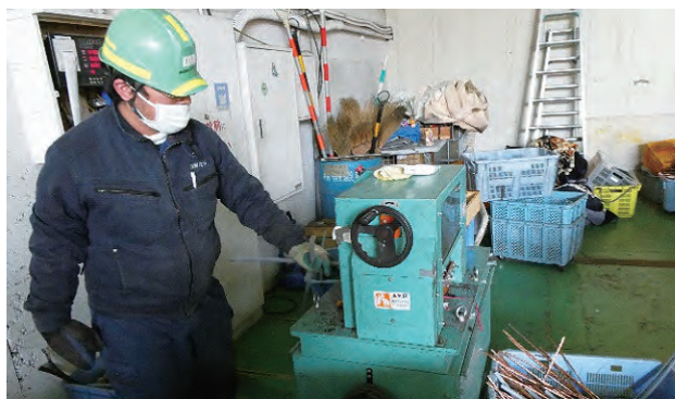
被覆銅線を剥離する機械を操作、効率性が増した
