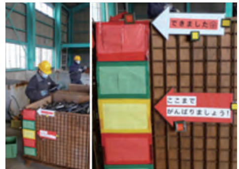
電線の分解・分別における作業効率の向上ツール（頑張り棒+矢印）の導入
