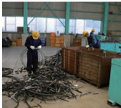
送電線の鉄とアルミの分別作業
