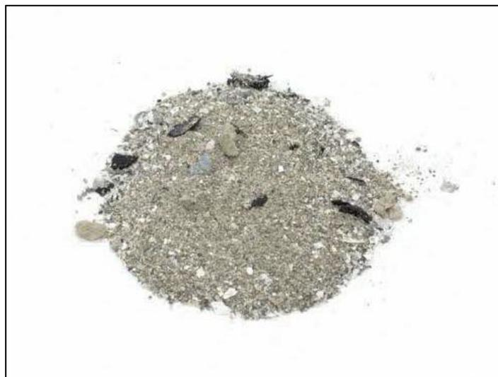
図 3-3 1号炉サンプリング灰（スーパーヒーター入口）
