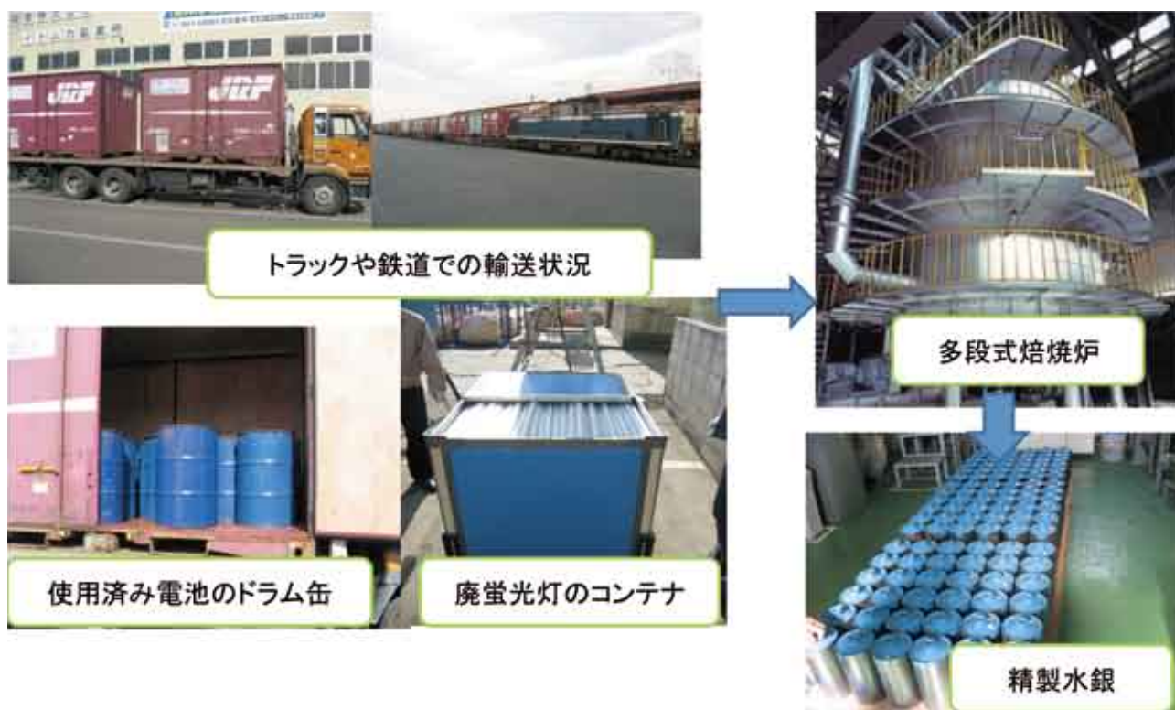
図 20 国内鉱業所における使用済み製品からの水銀の回収の様子
