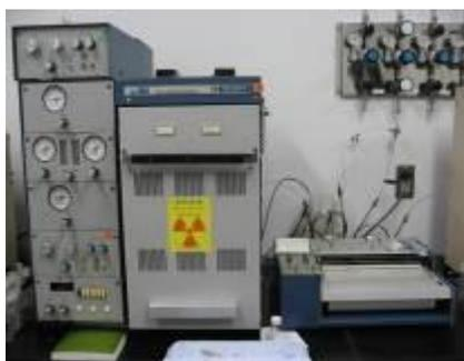
电子捕获检出，气相色谱法装置
