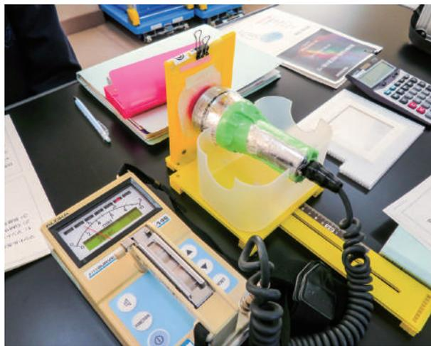
次にマントルから出る放射線の遮蔽にどのような違いが出るか、アクリル板、アルミ板、鉛板を使用して調べました。アクリル板に比べアルミ板、鉛板の順でよく遮蔽されることが数字からわかります。アルミ板と鉛板で放射線量が大きく変わるわけではないのは、鉛自身からも放射線が出ているためということも山田先生から教わりました。
