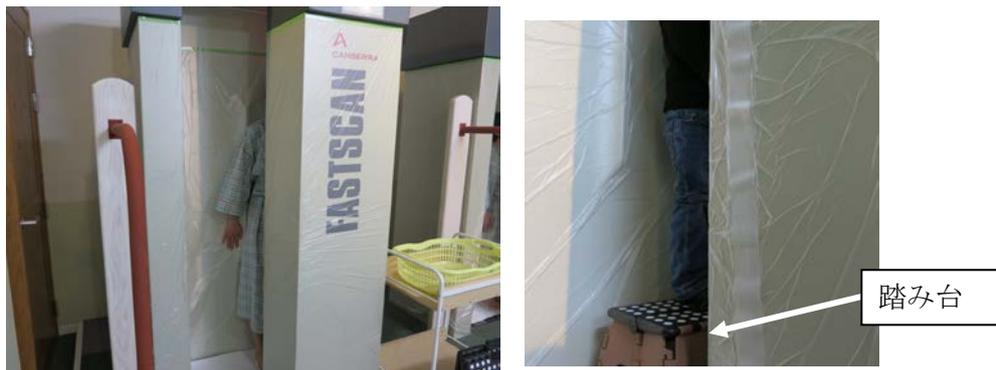
図3 キャンベラ社製の立位型 WBC 装置 FastScan による対象者測定風景（左図）、身長が 140 cm 以下の対象者は踏み台の上に乗って測定（右図）
