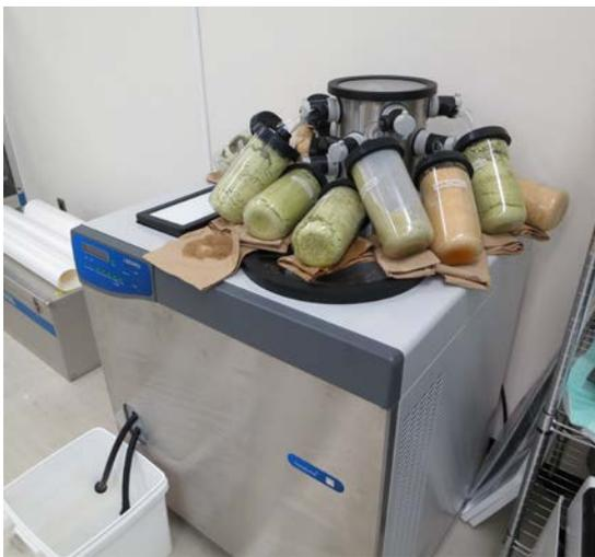
図 6 食事 1 日分（朝、昼、夜の 3 食分）をフリーズドライ装置による真空凍結乾燥の作業。
