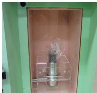
図 7 本研究で使用した Ge 半導体検出器（左図）、Ge 半導体検出器測定用の放射線遮蔽容器内への U-8 容器のセッティング風景（右図）
