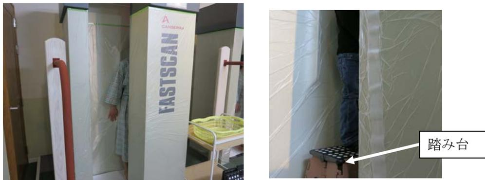
図4 キャンベラ社製の立位型ホールボディカウンター装置 FastScan による対象者測定風景（左図）、身長が 140 cm 以下の対象者は踏み台の上に乗って測定（右図）
