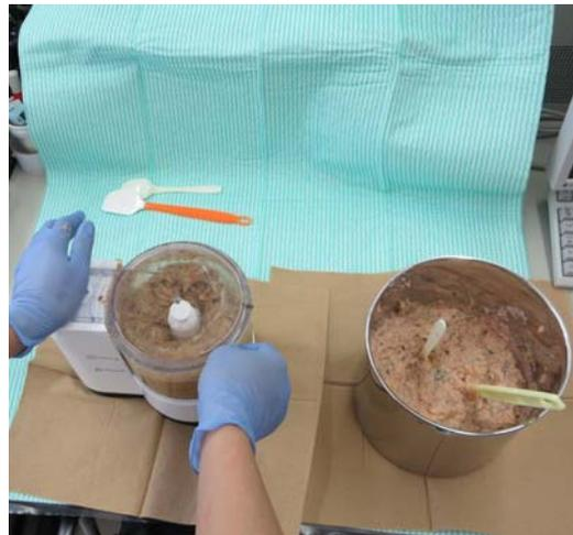
図4 食事2日分（朝、昼、夜の6食分）の重量測定（左図）とフードプロセッサによって細断して、ステンレス容器の中で攪拌、均一化の作業（右図）。
