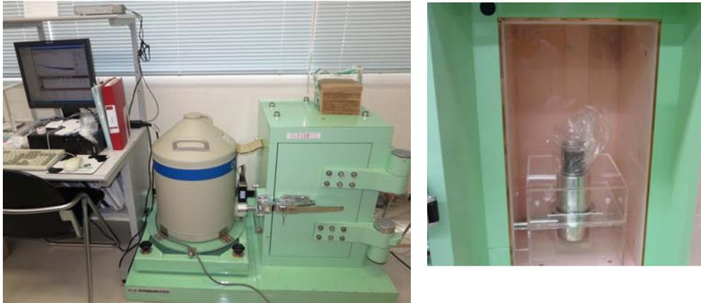
図6 本研究で使用した Ge 半導体検出器 (左図)、Ge 半導体検出器測定用の放射線遮蔽容器内への U-8 容器のセッティング風景 (右図)
