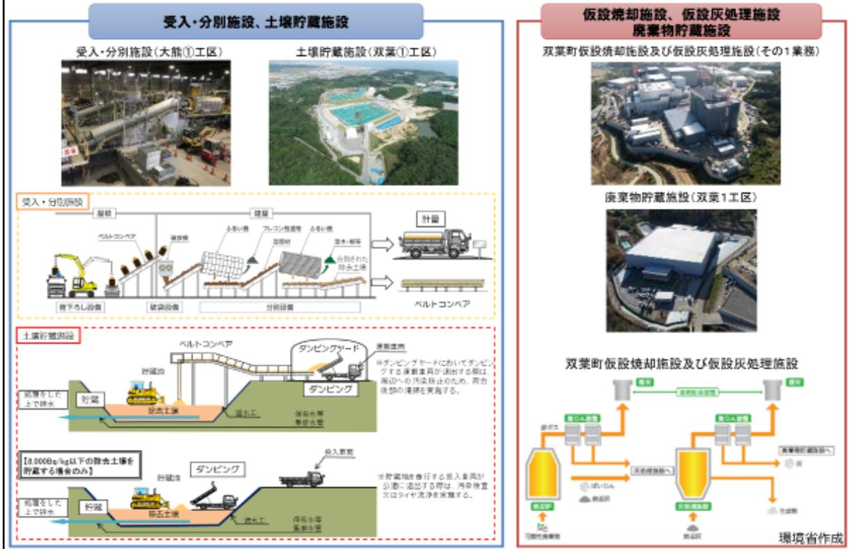
受入・分別施設では、福島県内各地にある仮置場等から中間貯蔵施設に搬入される除去土壌等を受け入れ、搬入車両からの荷下ろし、容器の破袋、可燃物・不燃物等の分別作業を行います。土壌貯蔵施設では、受入・分別施設で分別された除去土壌を放射能濃度やその他の特性に応じて安全に貯蔵します。また、廃棄物関連施設として、仮設焼却施設、仮設灰処理施設、廃棄物貯蔵施設を整備しています。仮設焼却施設では、除染廃棄物、災害廃棄物、草木などの可燃物を焼却し、減容化します。発生した焼却灰等は、さらに減容化をするため、仮設灰処理施設で熔融処理します。仮設灰処理施設で発生した灰は、鋼製の角形容器に封入して、鉄筋コンクリート造等の廃棄物貯蔵施設に貯蔵します。
