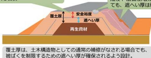
覆土厚は、土木構造物としての通常の補修がなされる場合でも、被ばくを制限するための遮へい厚が確保されるよう設計。
